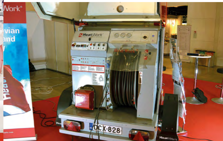
Laitteesta saadaan työmaalle sähköä ja lämpöä vaikka tiettömän taipaleen taakse, sitä voidaan siirtää jopa helikopterilla.
