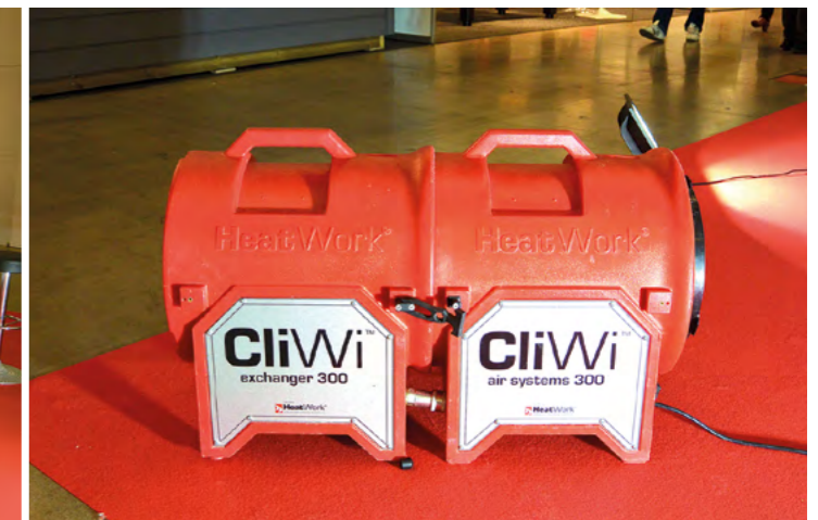
Heatwork AS valmistaa myös lämpöpuhaltimia jotka kootaan puhallin ja lämpökenno elementeistä. Lämmittimen tarvitsema sähkö ja lämpö tuotetaan roudansulatuslaitteistossa.
