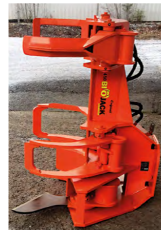
Biojack 450 EG uutuu on suurin malli ja tarkoitettu kaivukoneisiin. Yläkourat antavat tukea ja hallittavuutta tarkkaan työhön.
