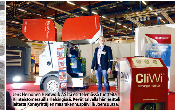
Laitteisto kulkee kevyesti pakettiauton perässä, MY 35 painaa vain tuhat kiloa.
