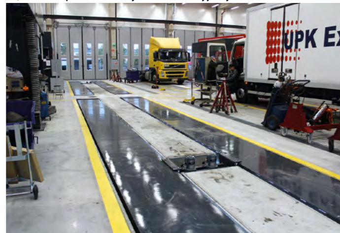
Siltanostureille mahtuu kerralla koko yhdistelmä täysperävaunuineen
