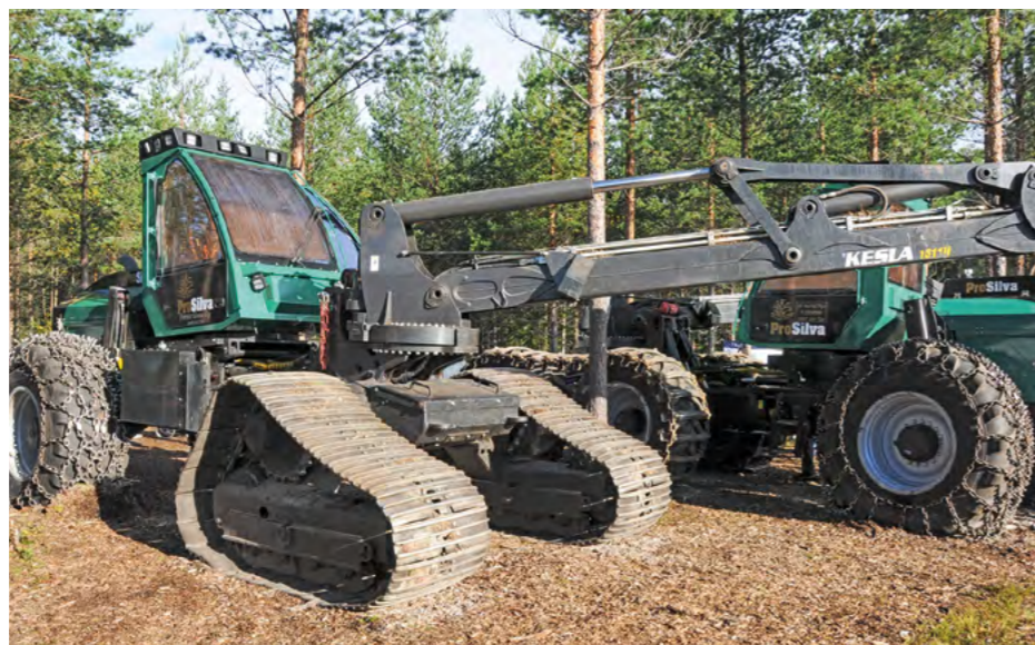
Prosilvan 5-sarja on uusiutunut uuden takarungon ja hydraulisesti vaimennetun ohjaamon osalta. Nelipyöräinen harvesteri voidaan varustaa nyt etuteloilla tai täysiteloilla.
