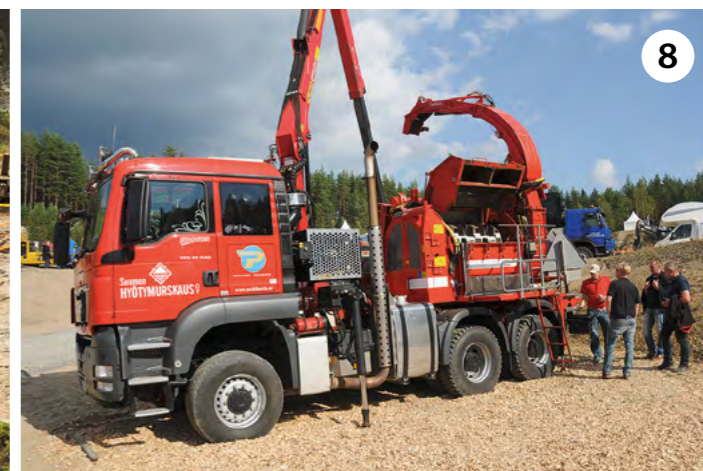
kuva 8 Salo-Machineryn osastolla oli MAN-alustalle tehty Suomen Hyötymurskauksen upea auto. Eschböck-murskainta pyöritetään suoraan auton moottorilla.
