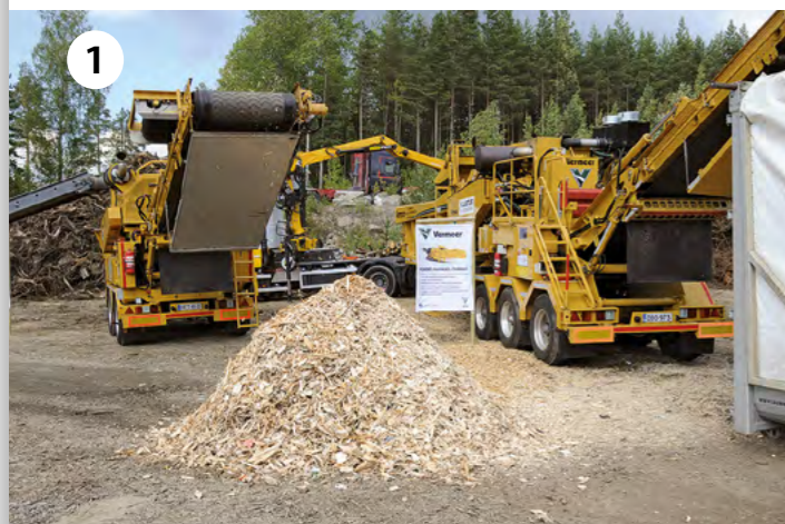
kuva 4 Lusissa toimivan Kone Saksman Oy:n MB Crusher BF 120.4 murskakauha säästää kuljetuskustannuksia, kun rakennusjätteissä oleva betoni-, tiili- ja asfalttijäte voidaan käsitellä ja hyödyntää purkutyömaalla.
