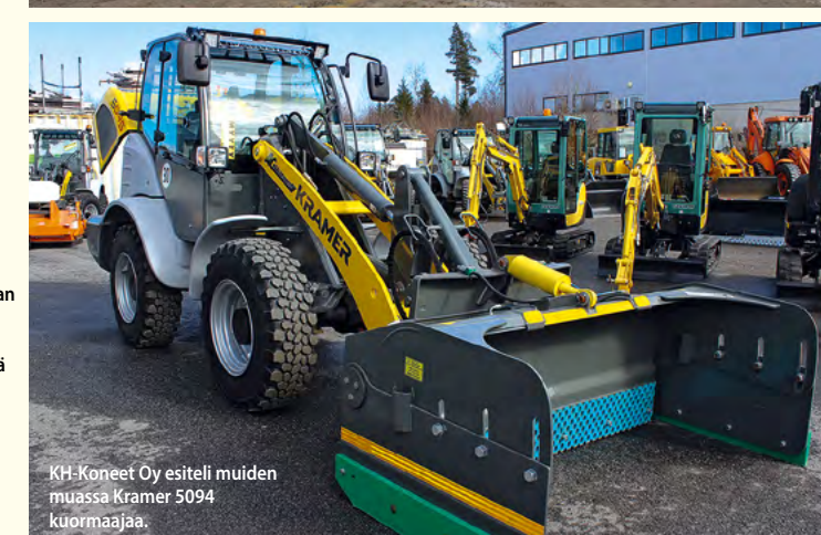
Allu Finland esitteli yläseulaa kirvesterillä varustettuna. Laitte soveltuu esimerkiksi viherjätteen murskaukseen.
