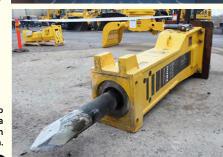
Atlas Copcon Kimmo Alakoski esitteli uutta MB 1700 Dust Protection pölysuojattua iskuvasaraa.
