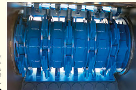
Viper Metal Oy:n suunnittelema ja valmistama rumpumurskainkauhua murskaa myös betonia ja tiiltä, kertoi Arto Ulvo Viper Metal Oy:stä.
