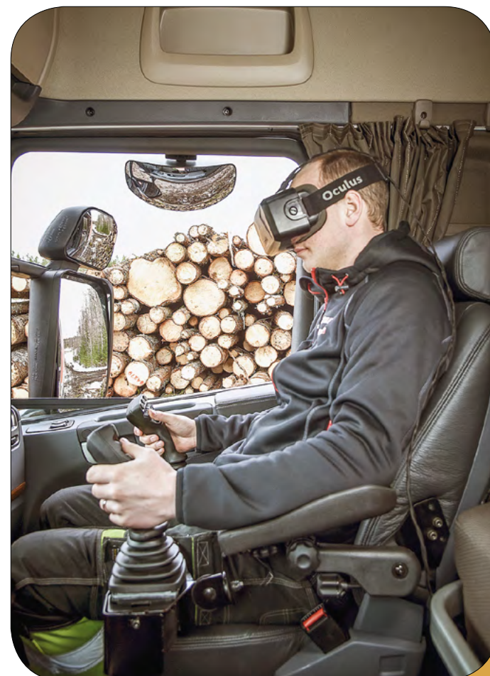
Oculus Rift lasit ja ohjaimet ovat käytössä kuorma-auton hytissä, erillistä kuormaimen ohjaamoa ei ole.
