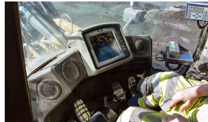
Mikä puuttuu? Nykyään suuremmissa pyöräkuormaajissa ei ole enää ohjauspyörää.
