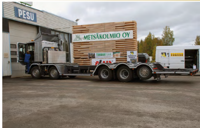
Viimeiset sähkötyöt tehtiin vielä hetkeä ennen koneenluovutusta. Erikoispitkässä lavetissa metrin lisäpituus on jaettu niin, että akseliväli on nyt 6300 mm ja perään saatiin 40 cm lisää mitta.
