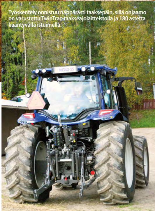
Päivittävät huolto- ja tarkistuskohteet on pyritty sijoittamaan helposti näkövälille ja saavutettaviksi. Vaihteistoöljyn tarkistussikkuna löytyy traktorin perästä.
