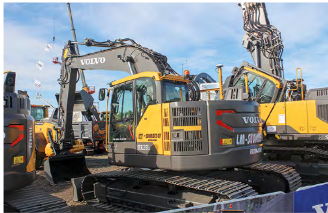
LM-Suomiset Oy:lle Eurajoelle oli menossa lyhytperäinen Volvo ECR235EL. Koneen paino on noin 25 tonnia ja moottorin teho on 175 hevosvoimaa. Kone on varustettu puskulevyllä.
