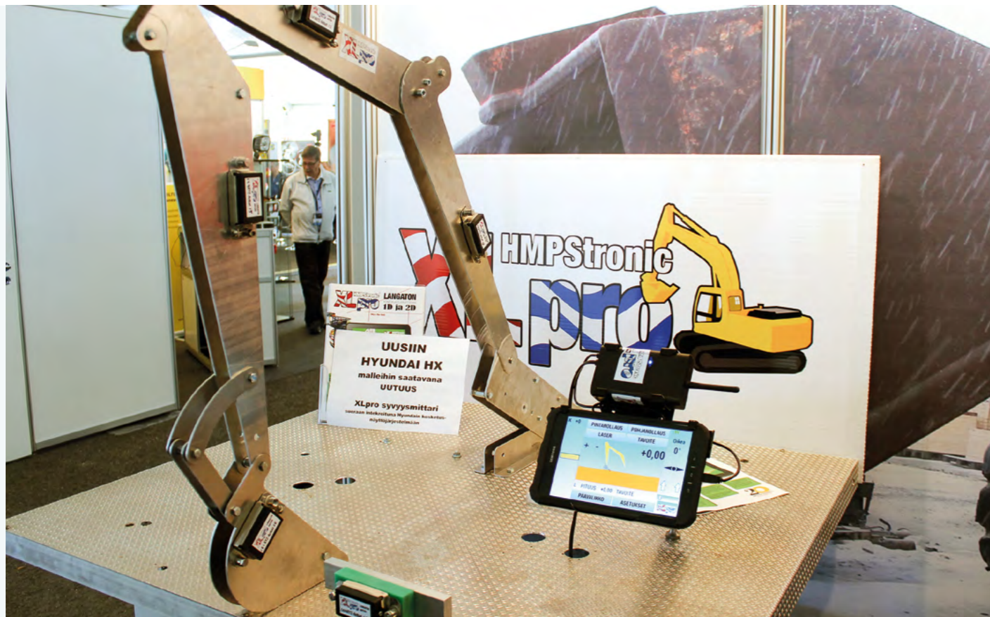
Uusi HMPStronic XLpro on langaton koneohjausjärjestelmä, kertoi Markku Salomäki Techbelar Oy:stä. HMPStronic XLpro on Suomessa valmistettu kuljettajaa opastava mittausjärjestelmä. Anturit asennetaan eri puomin osiin. HMPStronic XLpro on integroitavissa Hyundai kosketusnäyttöjärjestelmään.
