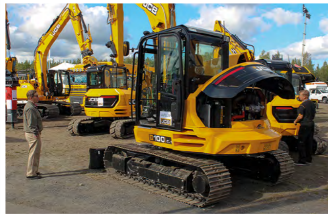
Matekon osastolla oli uutuuksia JCB 100 C1, jonka paino on noin 10 tonnia ja moottorin teho on noin 55 kilowattia.
