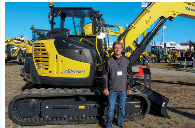
Yanmar SV 100-2 on 10,5 tonnin painoinen kone. Puomi on aiempaa pidempi. Koneen leveys on 2,32 metriä eli se mahtuu edelleen kuorma-auton lavalle, kertoi Timo Sakari KH-Koneilta.
