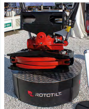
Rototilt R 4, 6 ja 8 on uudistettu ja isoimman pään malleja. Rototilteissa on propo-ohjaus sekä turvalukitus, josta tulee ohjaamoon signaali jos lukitus ei lukkiudu. Rototiltillä oli esillä myös maantiivistäjä sekä kauhoja 22 tonniin saakka.
