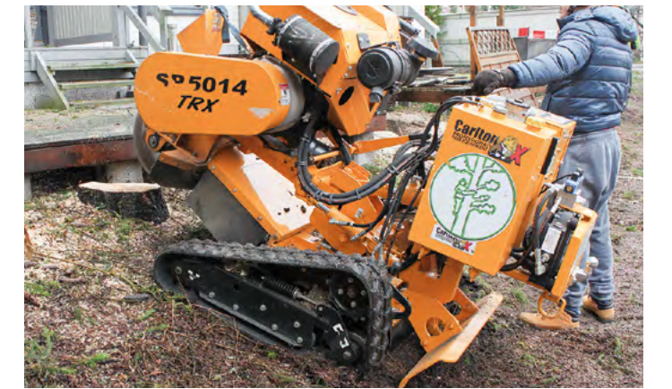
Perälevy on tarpeellinen lisävaruste jyrinnässä esim. kaltevilla paikoilla koneen vakauttamiseen sekä jyrinäjäljen tasaukseen.
