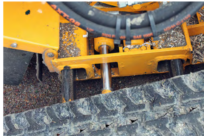
Kantojyrsin on vain 89 cm leveä, mutta hydraulisesti teloja voidaan levittää 20 cm kummallekin puolelle. Työkoneen vakavuus paranee.
