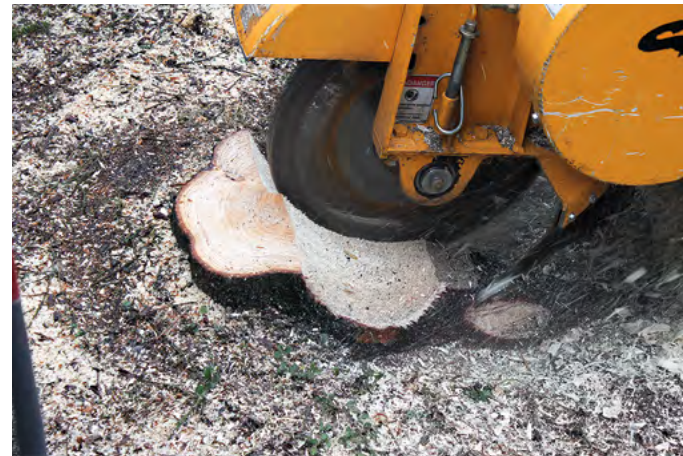
Kaksoisterillä varustettu jyrsimen kiekoterä on läpimitaltaan 53 cm ja sillä päästään 35 cm jyrsintäsyvyyteen.
