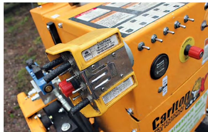
Kauko-ohjain kiinnittyy magneetilla koneen suojakoppaan.
