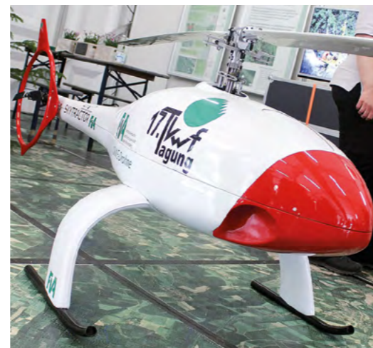
Stuttgartin yliopiston IFB Instituutissa kehitetty AMPAIRE 1 & 2 radio-ohjattu helikopteri mahdollistaa metsien ja esimerkiksi metsätuhojen ilmakuvauksen. 3 metrisiä roottorinlappoja pyörittää 10 kilowatin sähkömoottori, joka mahdollistaa enintään 60 kg lentoonlähtöpainon. Konseptitasolla oltiin myös mietitty raskaampaa kaksiroottorista radio-ohjattua helikopteria, tällä voitaisiin levittää esimerkiksi torjuntaineita.
