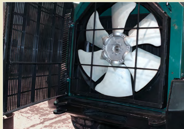
Järeä tuuletin puhdistaa itse jäähdytinsäleiköt. Toiminta on joko automaattista tai kuljettajan toimesta suoritettavaa. Tuuletin ja sen ohjaus on hydraulisesti toimiva.
