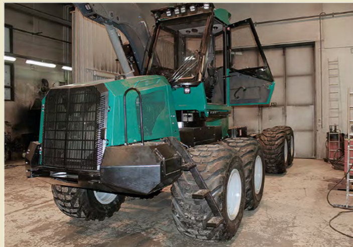
Logman on uudistanut täysin Combikoneen eli Logman LC 8 mallin. Sama alusta toimii sekä combikoneen alustana, että Fixterialustana.
