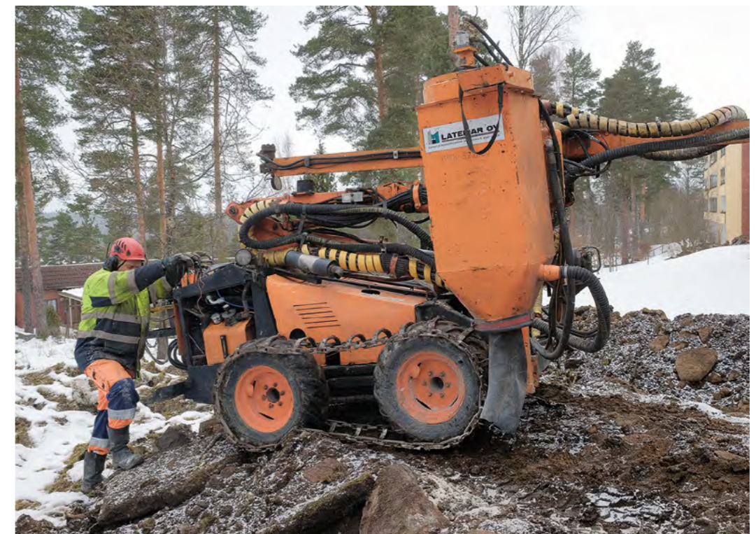
Poravaunuun on lisätty kiilalaitteelle ja sen polttomoottorille omat pidikkeensä, jotta noin viisikymmentä kiloa painavaa kiilalaitetta ja sen moottoria ei tarvitsisi erikseen kanniskella työmailla.
