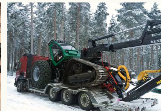
Prosilva koneet menevät kuljetusasennossa matalaan tilaan. Tämä on tärkeä ominaisuus matalalla olevien sähköjohtojen ja siltojen alituksissa.
