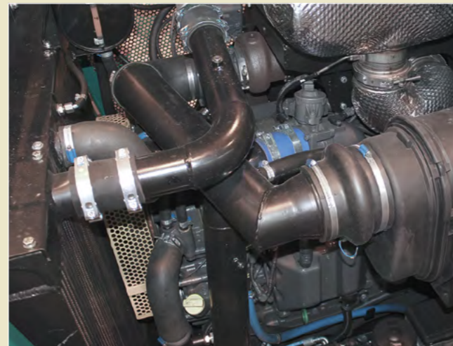
Moottorina Logman koneissa on Agco Powerin 6-sylinteriset Tier 4 moottorit.
