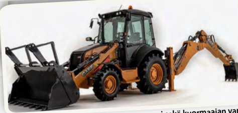
Case 580ST kaivureissa on uusi kaivupuomi sekä kuormaajan varret. Näiden geometria lisää näkyvyyttä ja parantaa irrotusvoimaa.
