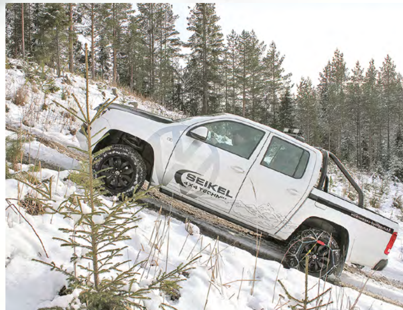
Amarok SEIKEL-neliveto lähtee jyrkässäkin rinteessä liikkeelle kevyesti. Etenemistä auttaa taka-akselilla olevat lumiketjut.
