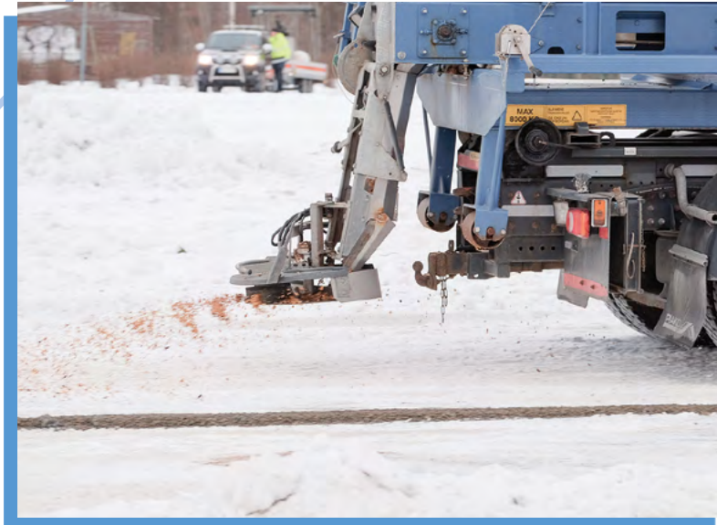
Lumenkäsittelyyn lisäksi Talvitiepäivien työnäytöksessä esiteltiin muun muassa YIT:n modifioima hiekoituslaite, jolla pystytään käyttämään puulastuja liukkauden torjuntaan.
