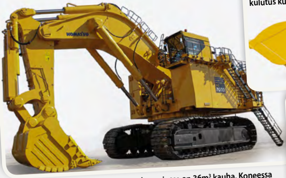
Komatsu PC7000 on 677 tonnin kaivokone, jossa on 36m³ kauh. Koneessa on kaksi 1250 kilowatin moottoria. Esillä myös 10- ja 11-sarjan kaivukoneita mm. leveätelainen PC170LC-10 ja lyhytperäinen PC138US-11.
