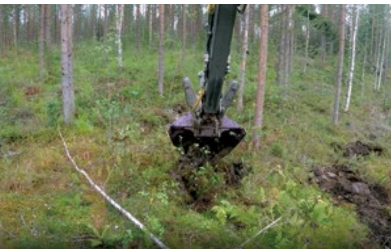
Näkymä kaivurin ohjaamosta: Ohjaamoon kiinnitetyn kameran avulla pystytään siirtämään opiskelijan tai työntekijän katselukulma samanlaisena ohjaajalle.
