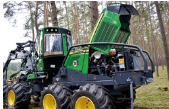
Moottoria on käännetty 180 astetta ja tuuletin on nyt takana, mikä on tehnyt ohjaamosta hiljaisemmän.
