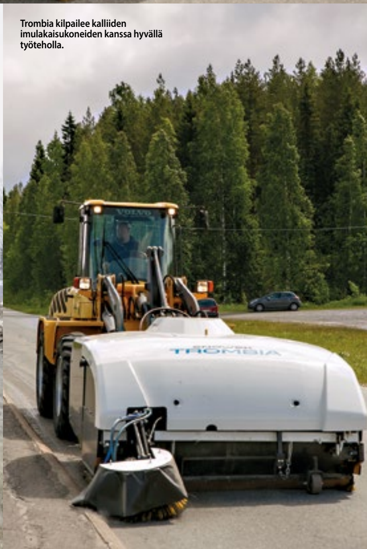
Trombian nyt myynnissä oleva 220-malli on tarkoitettu työpainoltaan yli yhdeksän tonnin pyöräkuormaajiin ja traktoreihin. Mallimerkki kuvaa työlevyitä.
