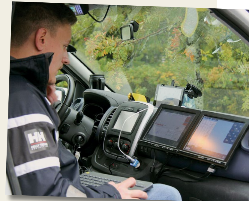
Road Doctor Survey Van -mittausauto kerää mittaustietoa noin 2 gigatavua mitattavaa tiekilometriä kohden ja tulevaisuudessa ehkä vieläkin enemmän.
