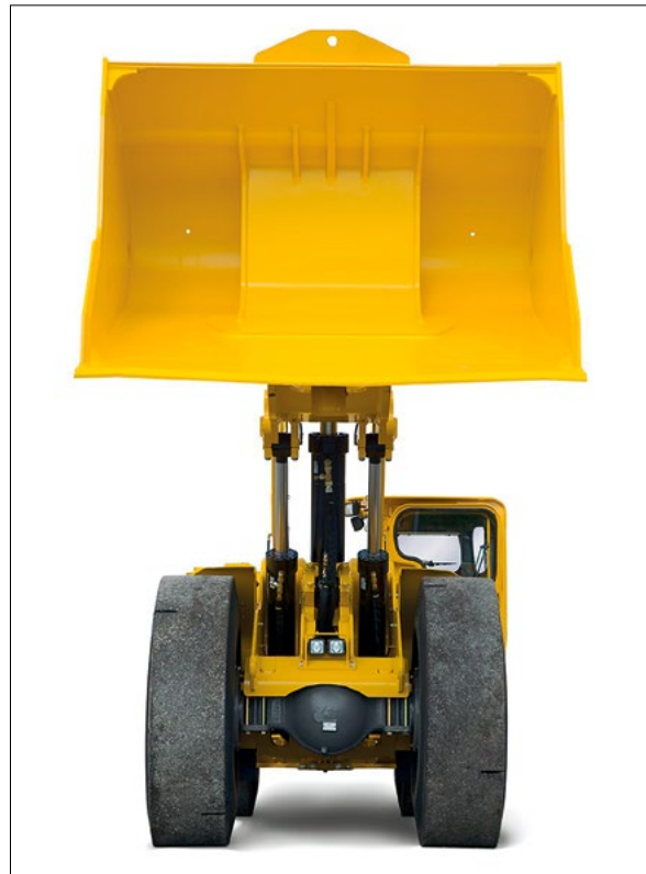
Epirocin maanalainen lastauslaite Scooptram 5T1030.
