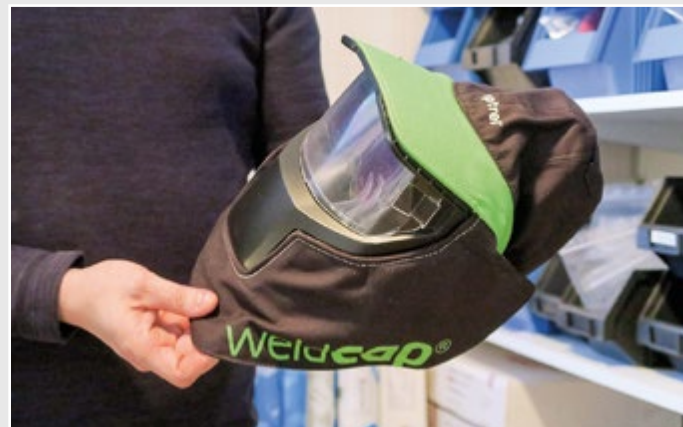
Pehmeän hitsausmaskin avulla pääsee ahtaampiin paikkoihin kuin perinteisellä.
