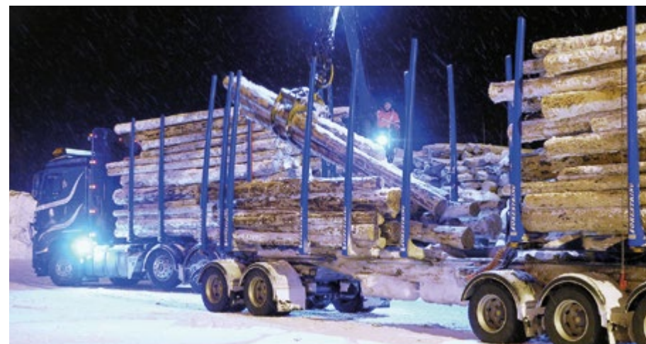
Kuljettaja hoitaa kuormauksen vetovaunun varusteena olevalla kuormaimella.
