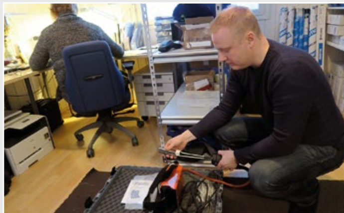
Induktiokuumennin on yksi tuote, jota on hyvä olla hyllyssä tarjolla. Kiinni ruostuneet pultit kun vaativat pikaisen avun.
