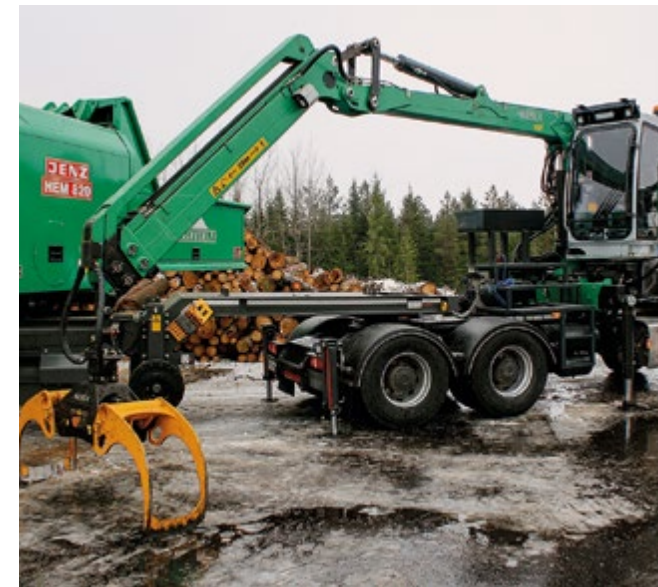
Jenz HEM 820 on puoliperävaunualustalla oleva terminaalikone. Nosturi on vetoauton rungolla etuosassa ja telien päällä on perävaunun vetopöytä.
