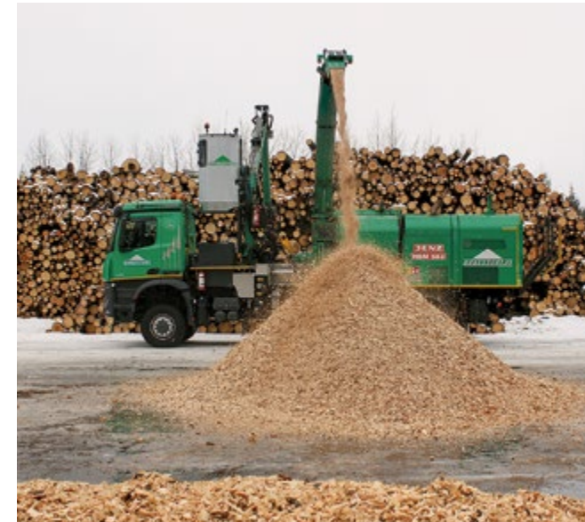
Hakevuoren viime syksyn hankinta Jenz HEM 583 on tienvarsihaketukseen hyvin soveltuva, mutta hybridinä soveltuu myös terminaalikäyttöön.
