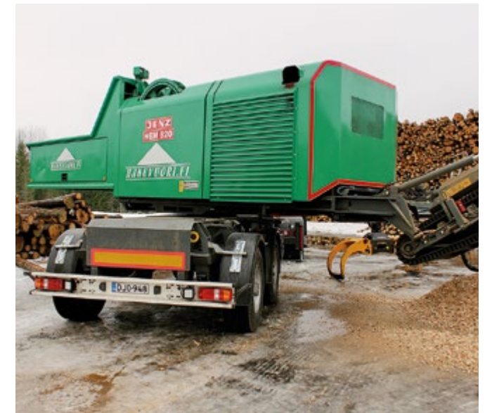
Jenz HEM 820 on pitkittäissyöttöinen. Koneen perästä lähtee kuljetin hakkeen siirtämiseksi kasalle.
