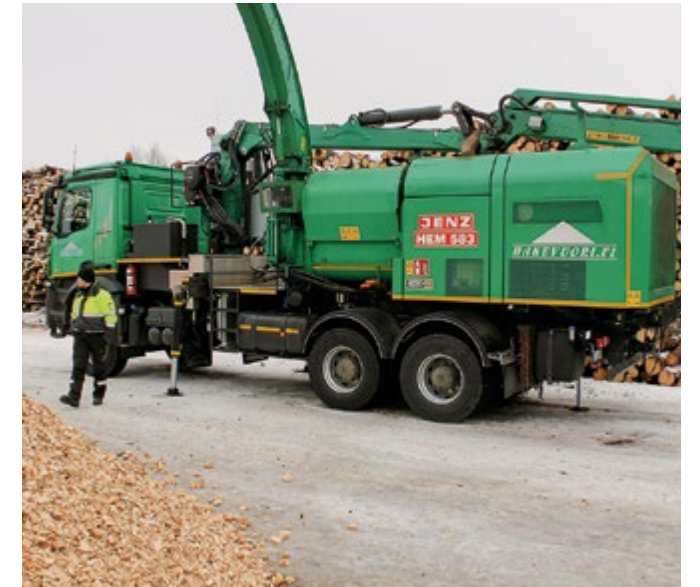
Jenz HEM 583 on sivuttaissyöttöinen tienvarsihakkuri. Mersun alustassa kaikki pyörät vetävät. Reijo Wuorion periaate on ollut, että jos pyörä ei vedä, niin se jarruttaa.
