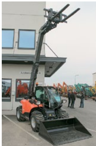
Konesilta Oy:n uutuus oli Kubota KTH 4815 kurottaja. Koneen paino on 3 tonnia ja nostokorkeus 4,8 metriä.
