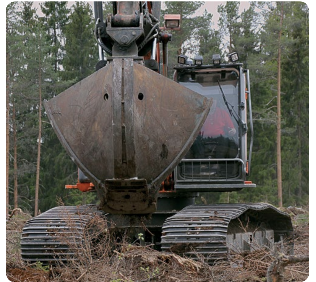
Juha Sirkkalan ojakaudesta muotoillulla mallilla onnistuu kaikki kaivinkonetyönä tehtävät muokkausmenetelmät. Lisäksi kauhaan voidaan asentaa SeedGun-kylvölaitteiston letkut.
