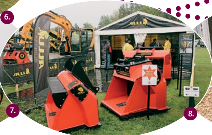
Kuva 9 Rototilt esitteli laajaa valikoimaansa. Uutuutena oli muun muassa lajittelukauha. Kauhoja on 4 mallia, jotka soveltuvat 12-25 tonnin koneisiin.
