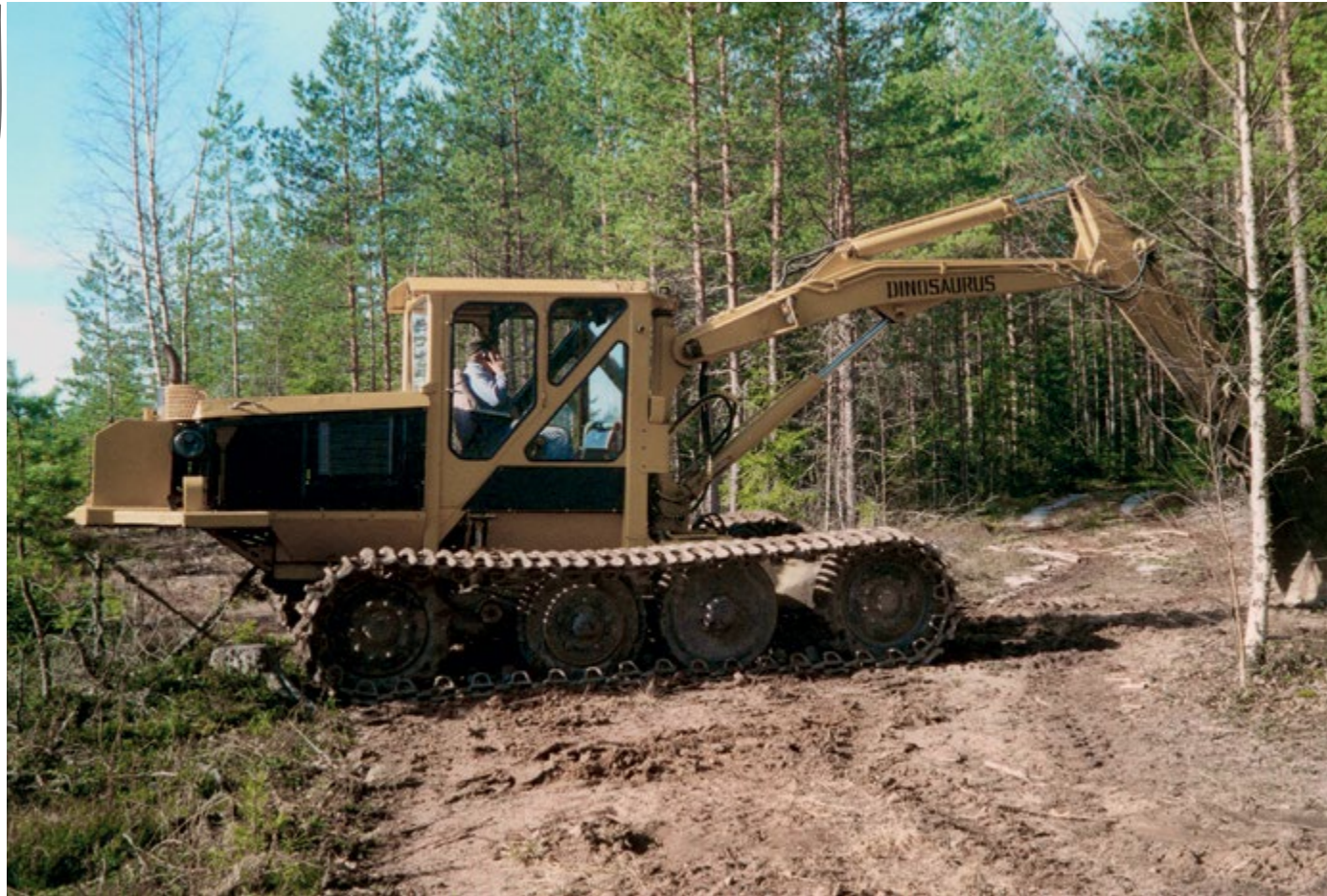
Vuonna 1986 valmistunut viimeinen Dinosaur on aikaisemmista poiketen varustettu Valmetin moottorilla ja sen kaikki akselit keskimäistä lukuun ottamatta on varustettu hydraulisylinterillä, joilla konetta voidaan painattaa maaston ja työn vaatimalla tavalla. Myös ulkonäkö on jo modernin kulmikas.
