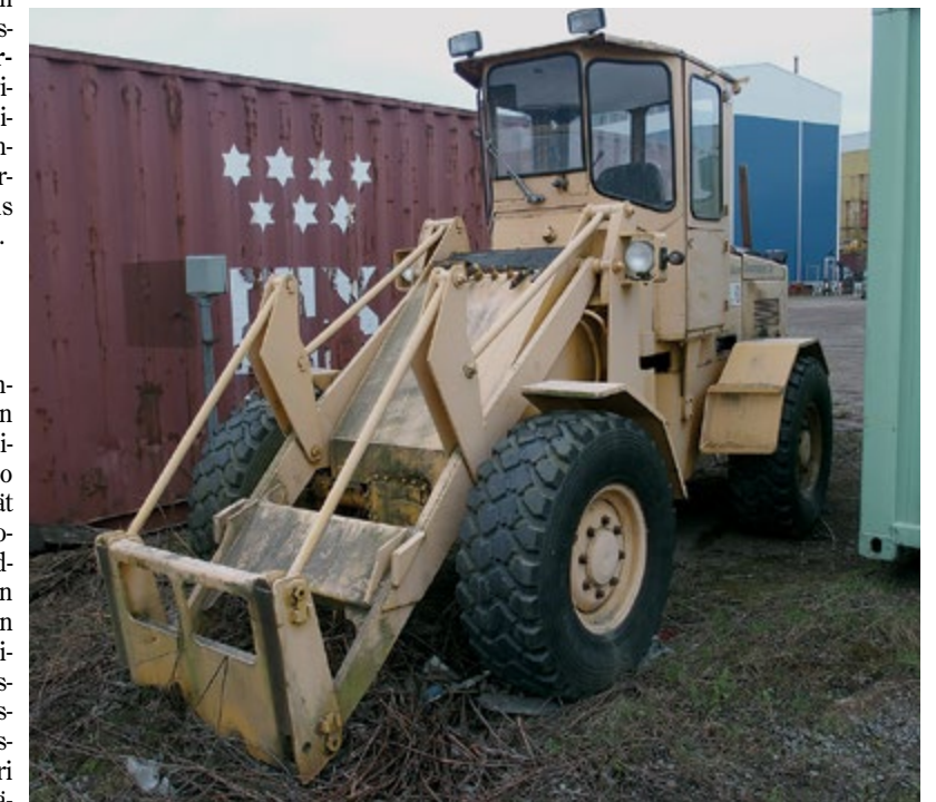
Eka M-75 oli kevyt runko-ohjattu pyöräkuormaaja aivan kansainvälisen mallin mukaan. Kotkan Kuorma Oy:n omassa käytössä ollut kone on hyvässä tallessa yrityksen varikolla Mussalon satamassa.
