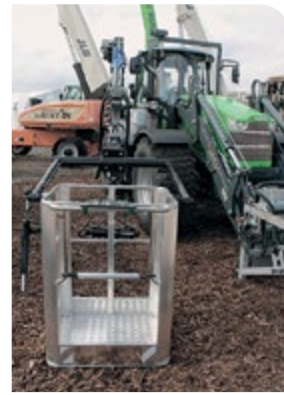
Lännen 1100 kuormausnostin on hyväksytty yhden henkilön korilla henkilönostokäyttöön.
