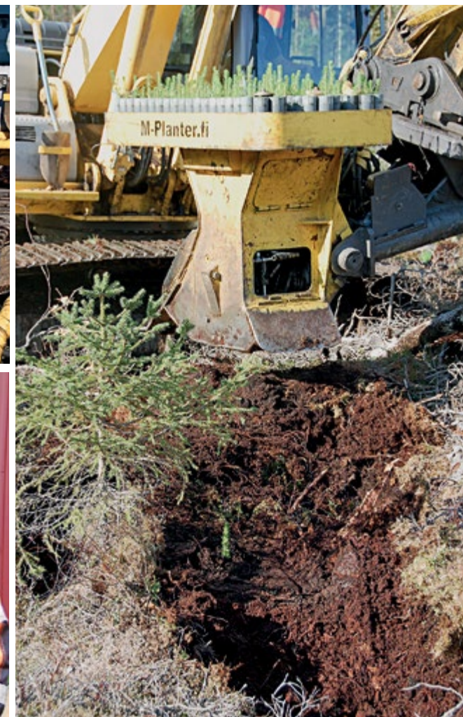
M-Planter istutuskone mätästää ja istuttaa samalla kertaa.
