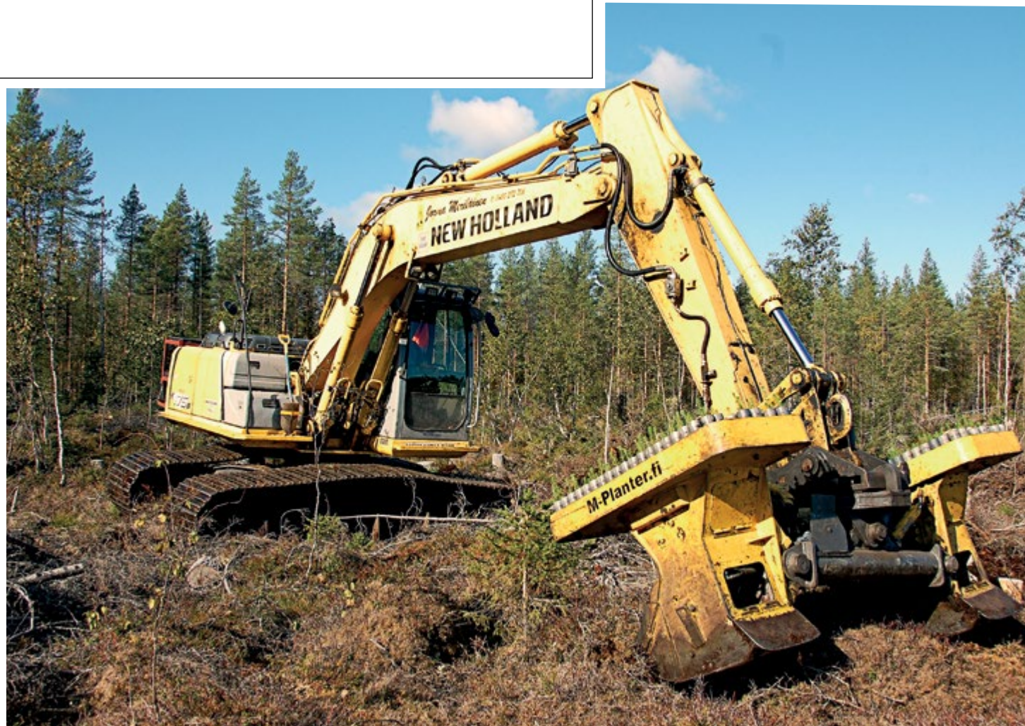
Paltamossa valmistettu M-Planter kaksipäinen mätästäv istutuskone työssään.
