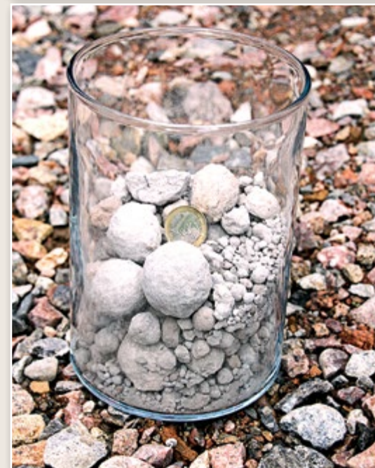
Tiellä käytettiin Ecolan INFRA® tuhka- aetta, raekoko 0-40 mm.
