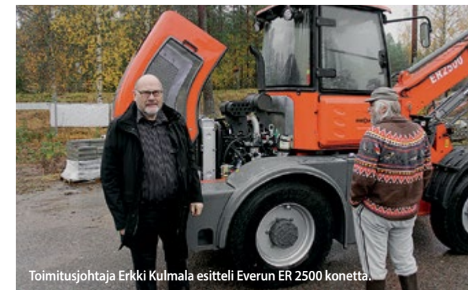
Everun ER 2500 koneessa on 55 kilowattinen Cumminsin moottori. Tämä kone oli menossa kiinteistöhuolto Jarkko Oy:lle.
