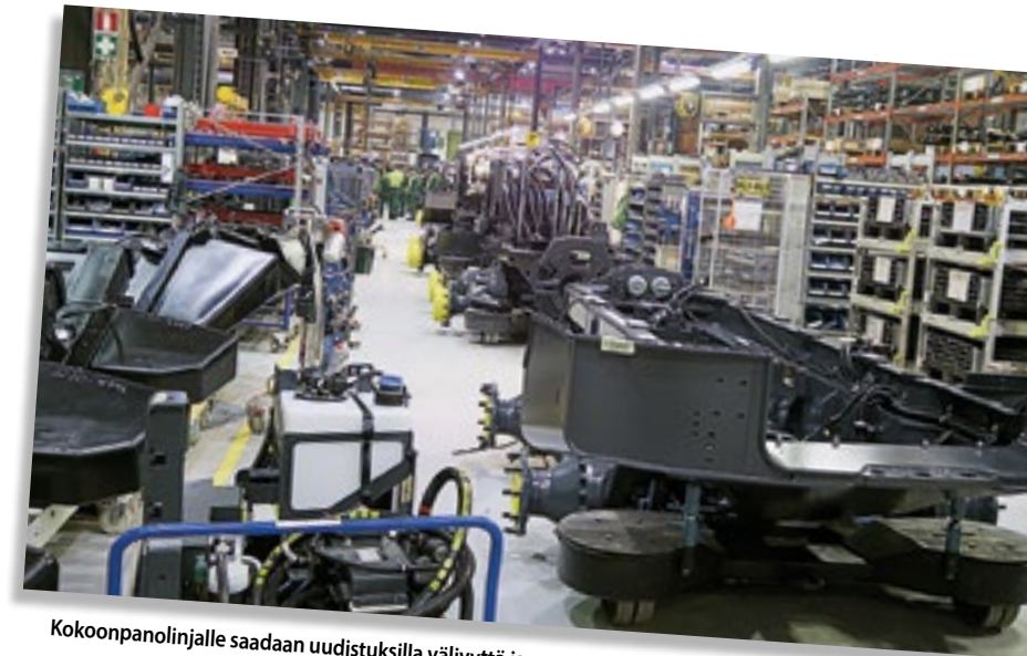
Tässä kokoonpanon vaiheessa koneet saavat pyörät alleen ja ovat valmiita koekäyttöön.
