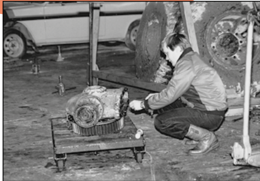
Timo Rautanen on myös yksi kirjaan haastatelluista yrittäjistä. Tämä kirjassakin julkaistu kuva on Koneyrittäjä-lehden arkistosta. Vuosiluku on hukassa, mutta kuvan taustalla on kuvateksti: "Jäätymättömät maapohjat aiheuttavat ylimääräistä rasitetta monitoimikoneen voimansiirtojärjestelmälle. Urakoitsija Timo Rautasen koneelle on tullut hammaspyörähuolia."
