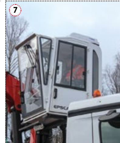
Kuva 5 Hakkurille on oma ohjaamo, josta haketusta hallitaan. Tässä on hakkurin ohjauspaneeli.
