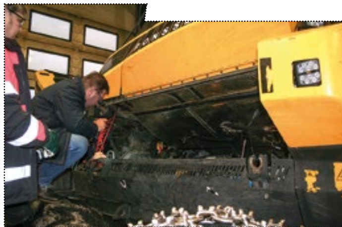
Koneen hytti on nostettu ylös. Sen alta tarkistetaan sähköjohtojen ja putkien läpivientien kuntoa sekä hytin alle mahdollisesti kertynyttä palokuormaa.
