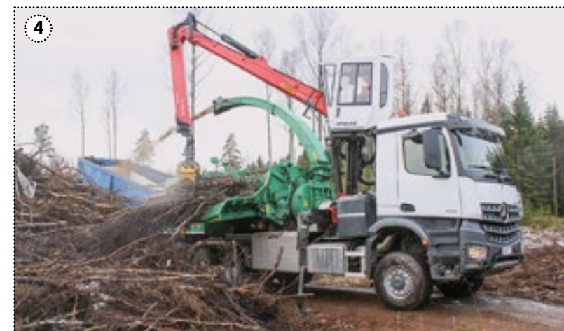
Kuva 4 Jenz Hem 583 hakkuri on kiinteästi sivusta syöttävä, nosturi on Palfinger Epsilon ja alustana on 6-pyörävetoinen Mersun Arocs 3351.
