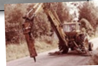
Roxon-iskuvasara kiinnitettynä vuonna 1977 tyyppilliseen peruskoneeseen eli traktorikaivuriin (kuva eMobilia)
