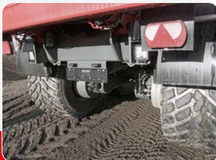
Leveiden renkaidensa ansiosta perävaunu päihittää dumperitkin pehmeiköällä. Black Bruinin hydraulimoottorit on sijoitettu takimmaiselle akselille.
