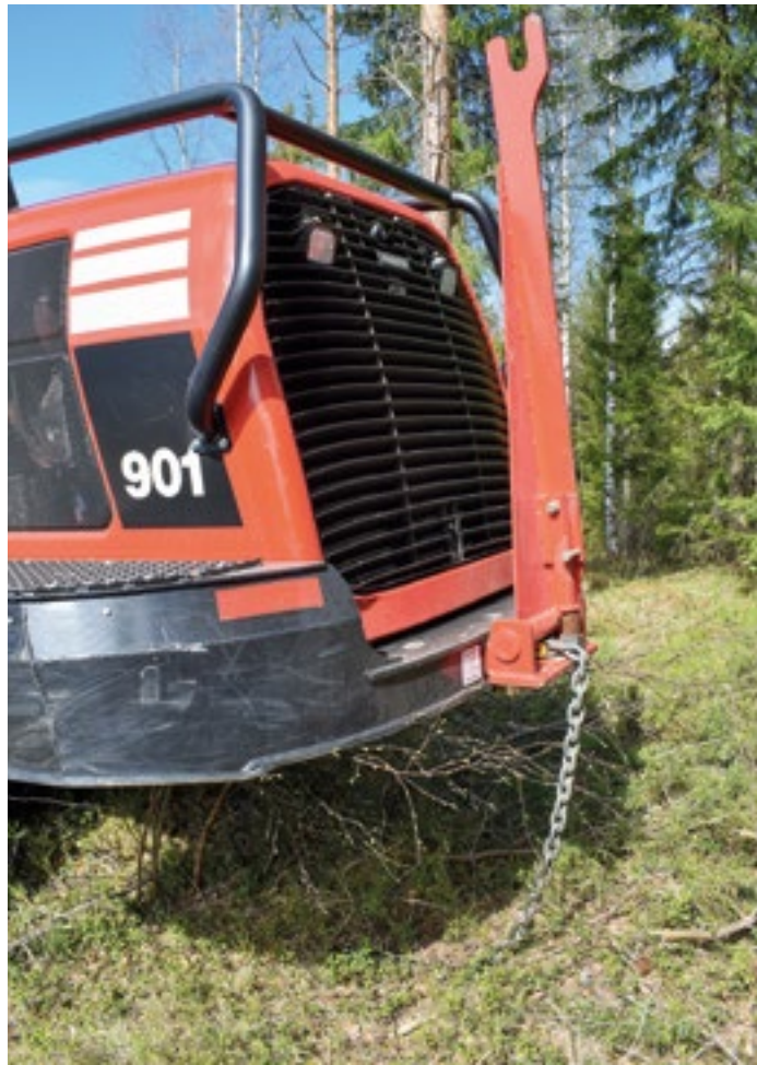
Laahausketju kuuluu koneen varustukseen tällä työmaalla.
