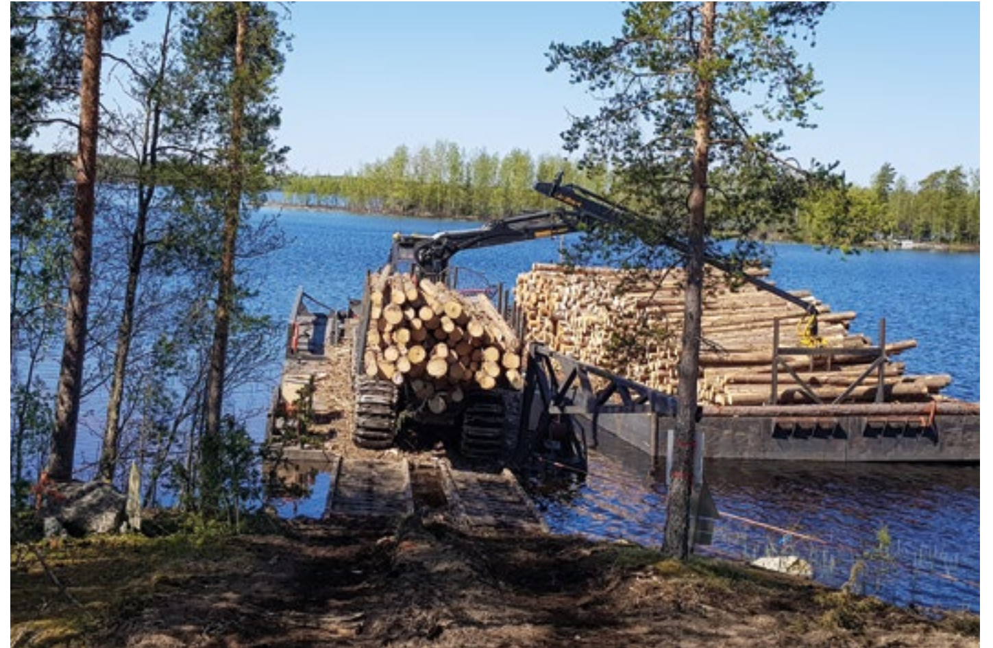
Ajokone purkaa puukuormaa omalta lautaltaan varsinaiselle puulautalle, jolla kuljetus tapahtuu mantereen nostopaikalle.
