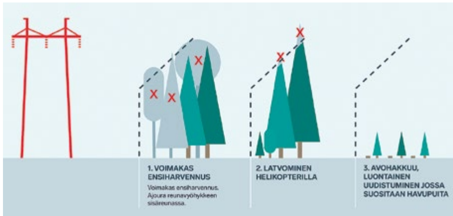
Suurjännitejohdon reunavyöhykkeen käsittelyketju, jossa mukana johdon omistajan teettämä latvasaha.
