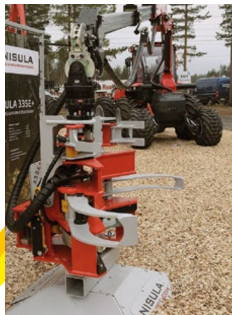
Nisula 355E+ energiakoura katkoo jopa 35 cm paksut puut. Kouran oma paino on 650 kg.
