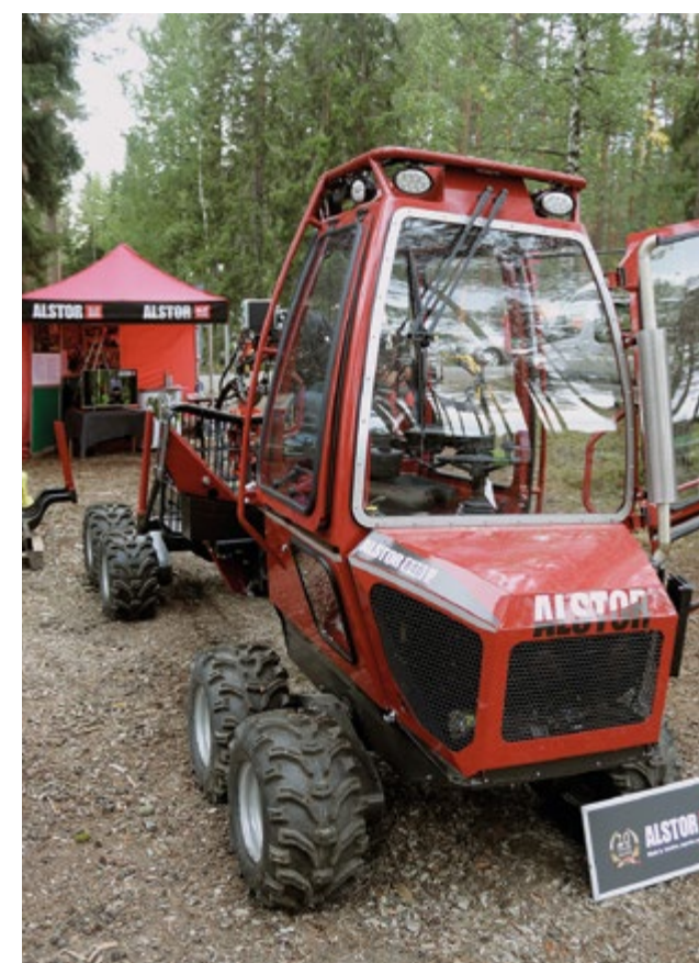
Alstor 840 Pro kombikoneen omapaino on 2450 kg maksimikuorma 3000 kg.
