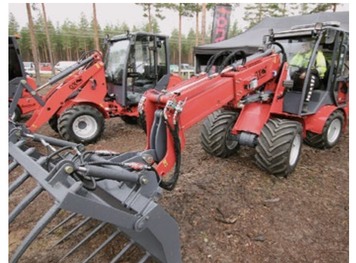
QX-sarjaan kuuluu toistaiseksi viisi pienkuormainta, joiden voimanlähteenä on Kubotan moottori. Keskinivelen kellunta pitää pyörät aina tukevasti maassa.
