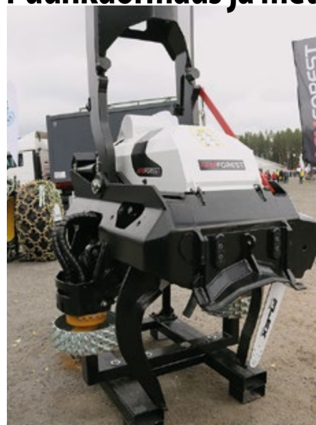
Näyttelyn suurin koura AFM 75 on 1800 kg painoinen tarkoitettu järeille alustakoneille ja laanikäyttöön. Latvasaha 57 cm laipalla ja pääsaha 90 cm.
