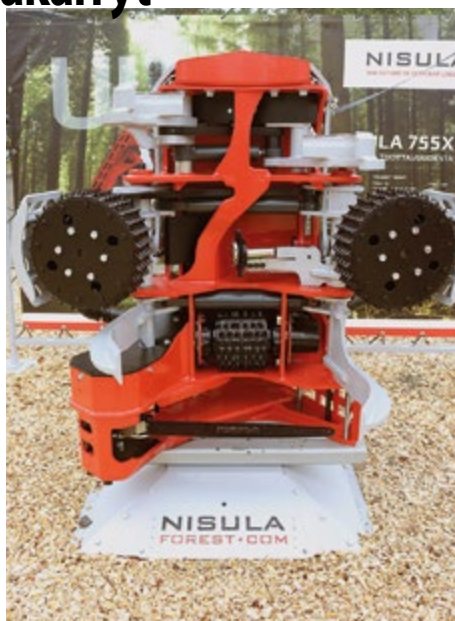
Nisulan historian suurimman kouran kaatoläpimitta on 75 cm ja se soveltuu parhaiten kaivinkonekäyttöön tai isoihin hakkukoneisiin.
