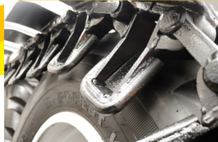
Restoren uusi telarakenne antaa hyvän sivuttaistuen.
