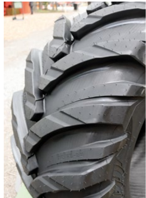
Nokian TRS2+ on suunniteltu nimenomaan teläkäyttöön siten, ettei tela pääse heilumaan. 710/55/34 koon saa myös älyrenkaana lähettimellä varustettuna.
