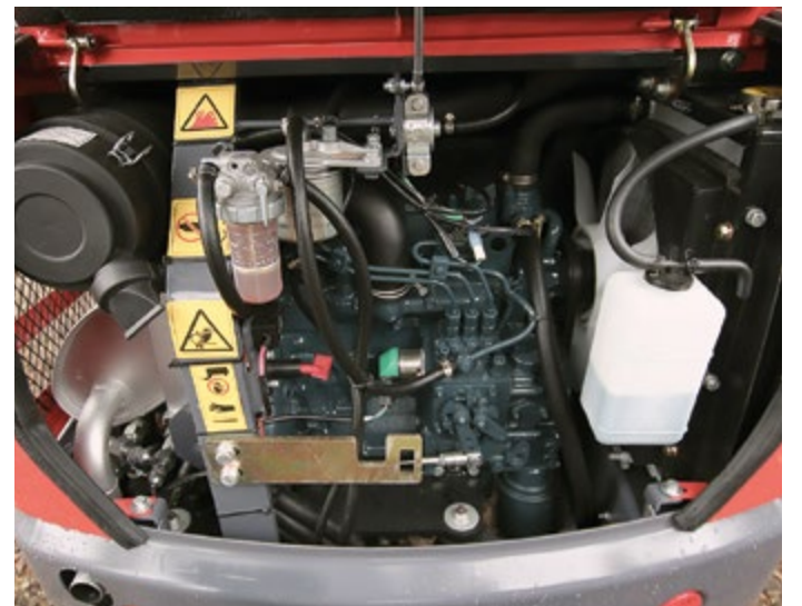
Huolto on helppoa, koska koko moottorinsuoja ja ohjaamo voidaan aukaista syrjään.
