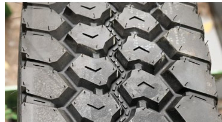
Puutavarakärryihin omanlainen karkeakuvioinen R-Truck Trailer, jonka uriin kivet eivät tartu herkästi.
