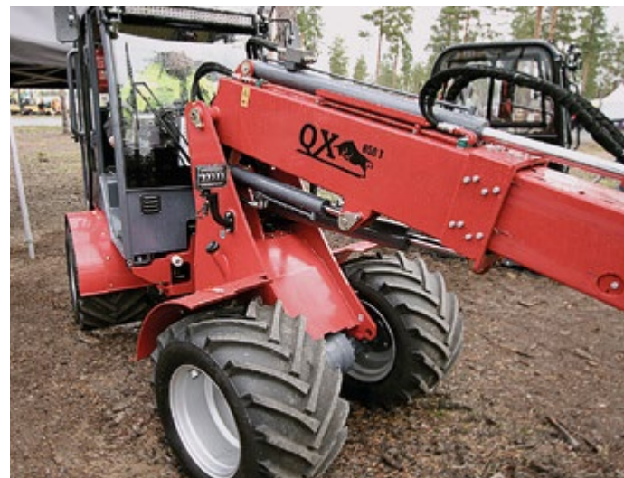
Sarjan suurin malli 850T on varustettu teleskooppipuumilla. Maksimi nostovoima on 2500 kg.
