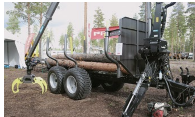
Hankkijan Palms 10U metsäperävaunun kantavuus on 12 t ja 5.85 kuormaimen ulottuvuus on 8,5 m. BlackRuin-napaveto päästää pinteestä.
