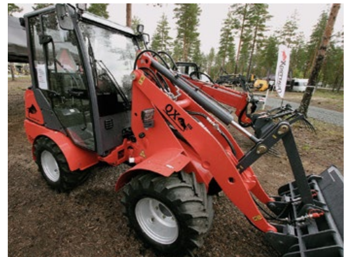
QX 820 -mallin on täydellinen kopio JCB 403:sta. Koneen omapaino on 2280 kg ja suurin nostovoima 1750 kg ja hinta 35 900 euroa.
