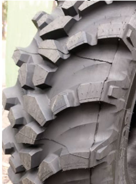
Ground King on hybridirengas, jonka kuvio takaa hyvät maantieominaisuudet mutta toimii myös peltotöissä. Keskellä on yhtenäinen tiheä kuvio, joka ei ajossa pidä ääntä eikä tärise mutta antaa kulutuskestävyyttä.
