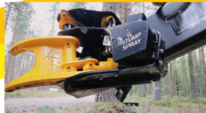
TKM-kouran Evo2 turbosylinteri antaa uutta puhtia katkaisuterälle. Kouran saa jatkossa myös kannonkäsittelylaitteistolla.
