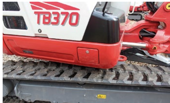
Takeuchi 370 on uusi 3-sarjan Takeuchi minikaivukone, uutuus nähtiin Honka Tradingin osastolla. Koneella on painoa 6,7 tonnia ja tehoa on 42 kilowattia.
