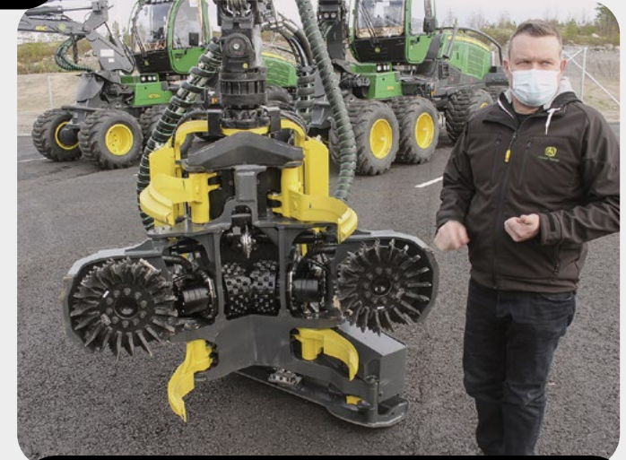
Antti Tanninen esitteli H424 kouran uusia parannuksia. Koura ottaa hyvin kiinni puusta ja myötäilee mutkaistakin puuta, kertoi Tanninen.
