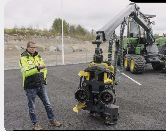
Junnonen Forest Oy:n Janne Junnonen on testannut uutta 1070G IBC konetta varustettuna H212 kouralla ja toteaa, että yhdistelmä tehostaa selkeästi työtä. Harvesteripää on kapea ja ketterä. Huollot on helppo tehdä yhdessä asennossa. IBC päätyvaimennukset parantavat mukavuutta ja koneen kestävyyttä.
