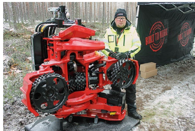
Waratahin Mika Laakso esitteli uudet H212 ja H424 harvesteripäät työnäytöksessä. Kuvassa uusi H424 harvesteripää.
