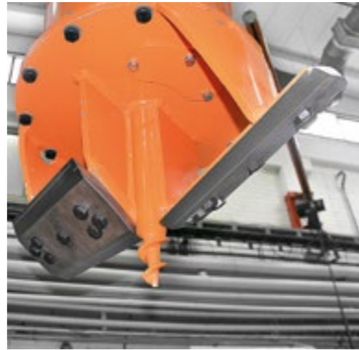
Kantomurskan terät muistuttavat pilkkikairan teriä, keskellä on kantoon pureutuva kierrekaira. Terät ovat käännettävissä, joten molemmat reunat voidaan hyödyntää.
