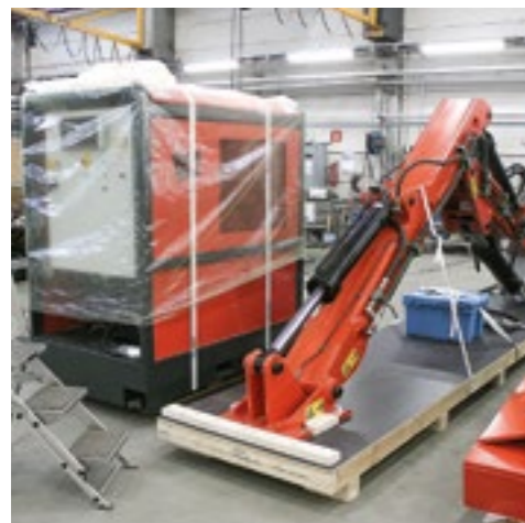
Tämä rikotuspuomi sähköisellä hydraulikoneikoinen on menossa Venäjälle. Venäjä on hyvä markkina tällaisille tuotteille, kertoi Kaj Koskela. Tämä hydraulikoneikko vaatii 400V jännitteen.
