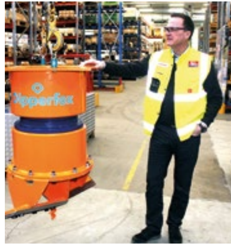
Marakon Oy aloitti Dipperfox kantomurskaimen maahantuonnin vuoden vaihteessa. Kaivukoneen puomiin kiinnitettävä murskain toimii pyörivällä kairausperiaatteella aivan kuin iso pilkkikaira. Kuvassa Marakonin toimitusjohtaja Kaj Koskela.
