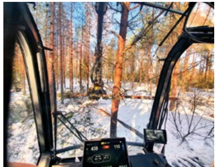
Uuden ohjaamon ikkunapinta-alaa on kasvatettu. Uusi yksiosainen etuikkuna ulottuu ohjaamon katolle. Kuva: Karttulan Metsätyö Oy
