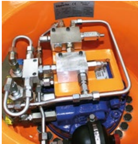
Tältä Dipperfox näyttää ylhäältä päin, se on varustettu myös paineakulla. Pohjalla näkyy kääntömoottori.
