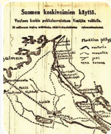
Suunnitelma vuodelta 1912 Vuoksen vesien ohjaamisesta Saimaalta suoraan Kuormanpohjan lahteen kanavalla. Kanava olisi vaatinut notkempien ylittämistä täyttömailla, mutta vastaavasti putouskorkeudeksi olisi saatu yli 60 metriä.
