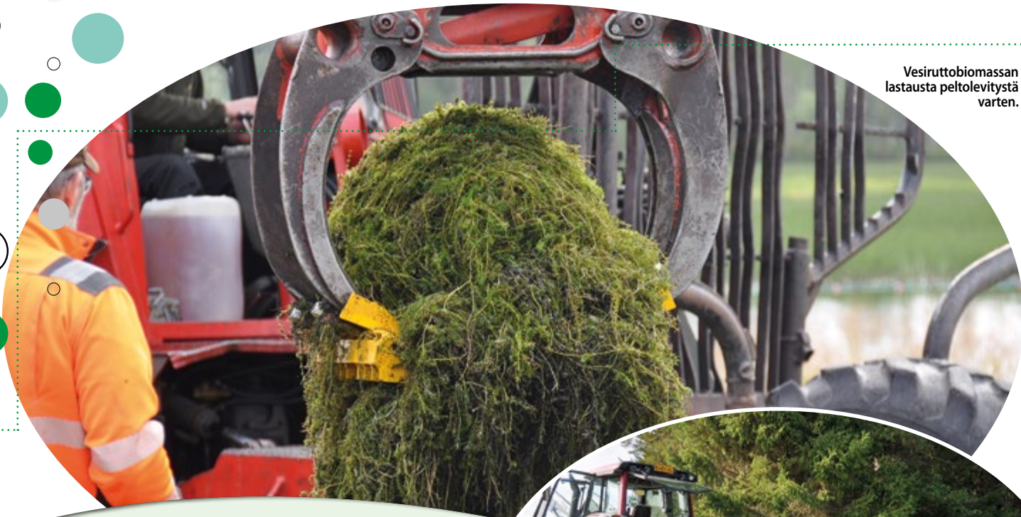
Vesiruton raivausnuottauksen lisälaitteet – traktoriharava metsäkoneeseen.
