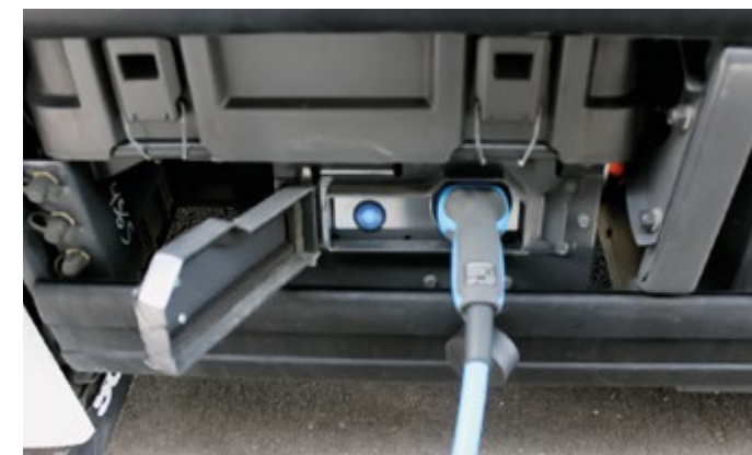
Lataushybridin pistoke laitetaan lastauksen ja purun ajaksi kiinni, jotta virtaa riittää jälleen paremmin eteenpäin.
