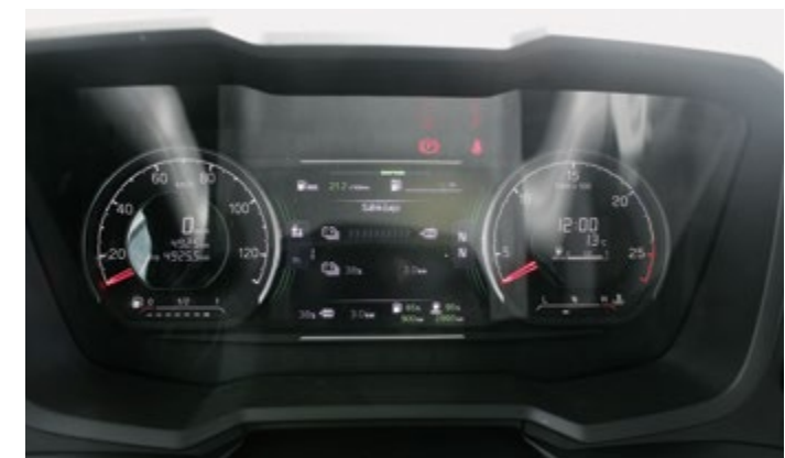
Sähköhybridin mittaristo on hieman erilainen. Siinä näkyy muun muassa akun varaus tilanne sekä se, että lataako vai purkako akkua.
