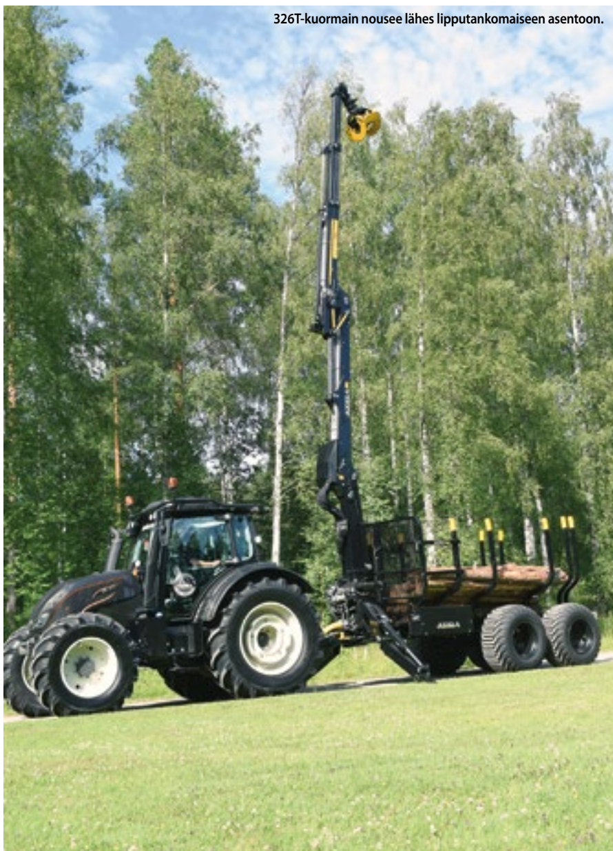
Uusi 326T-kuormain esiteltiin kesäkuun lopussa. Kuormaimen ulottuvuus on 9,1 metriä.
