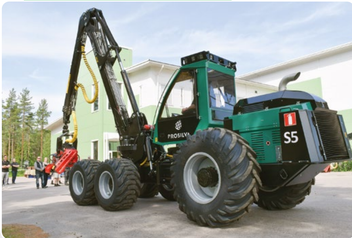
Uusi S5 esiteltiin Ruovedellä kesäkuussa. Kone on takaa keskiniveleen saakka sama kuin S3.
