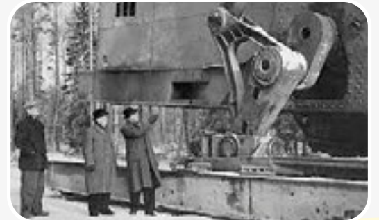
Kävelevän Marion-koneen tassut liikkuvat epäkeskoakselien välityksellä. Kymmenen metriä pitkät tassut siirtyivät joka kierroksella pari metriä. Kävelynopeus oli 240 metriä tunnissa!
