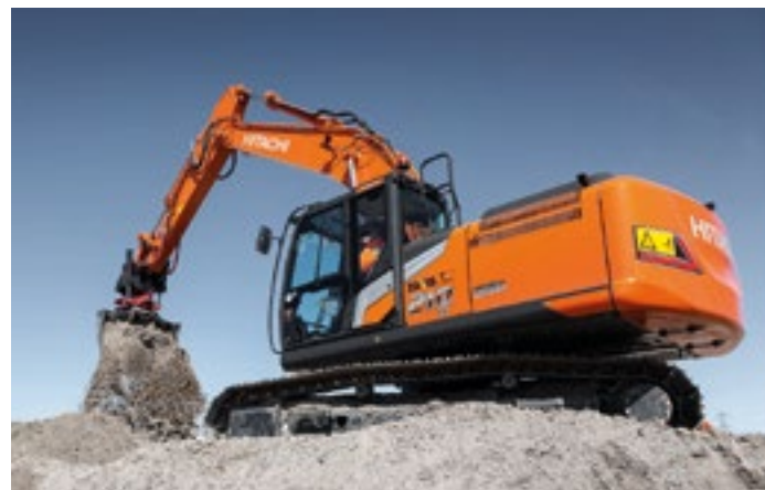
Hitachi ZX210LC-7 ja ZX225US/USR-7 koneissa on Isuzu 4HK1 moottorit, jossa on 128 kW tehoa. Näitä isommissa koneissa on myös Isuzu moottorit. Suomeen tuotavissa malleissa on vakiona pitkä alavaunu.
