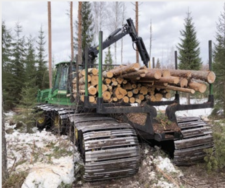
John Deere 810D on kokenut muodonmuutoksen, kun alle on sovitettu kantavat telat ja yksi pyöräpari lisää. Kuva Jussi Laurila.
