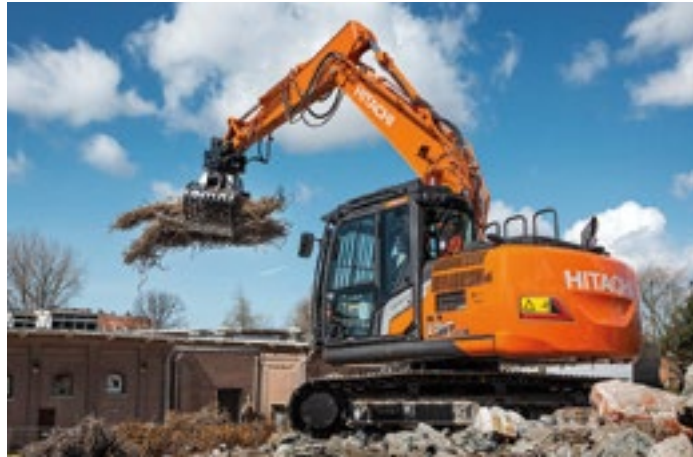
Hitachi ZX130LC-7 ja ZX135US-7 koneissa on Toyotan 1KDE moottori, jossa on 74 kW tehoa. Näissä moottoreissa ei ole ureajärjestelmää.
