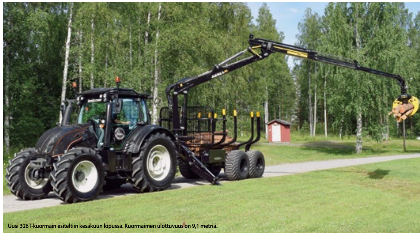
326T-kuormain nousee lähes lipputankomaiseen asentoon.
