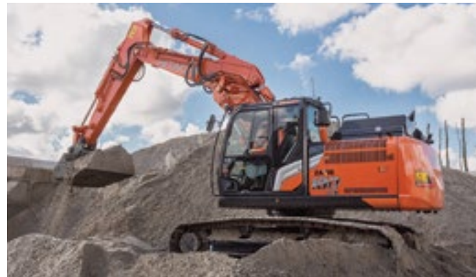
Hitachi ZX160LC-7 ja ZX180LC-7 koneissa on Yanmar 4TNV107 moottori 101 kW tehoisena. Hitachi ZX180-7 mallin pienentynyt kääntöympyrä mahdollistaa työskentelyn entistä ahtaimmista kohteista.
