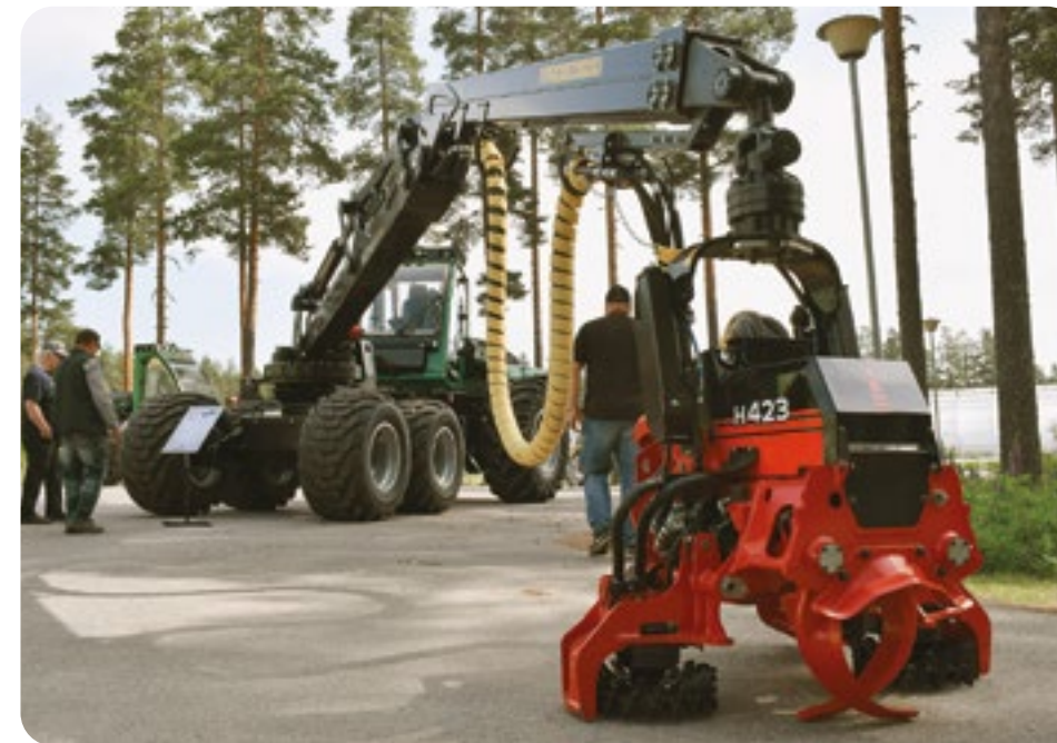
S5:n nosturijalusta on vahvistettua HD-mallia, mikä mahdollistaa suurempien nostureiden ja hakkuupäiden käytön.
