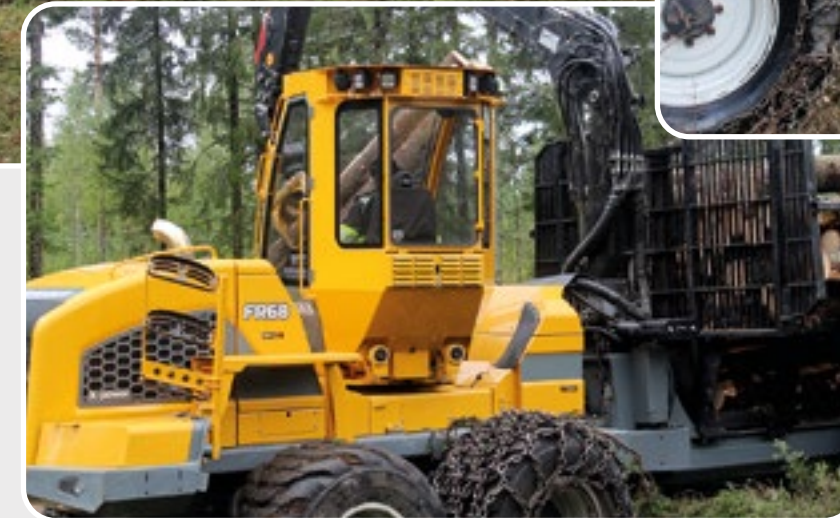
Ohjaamot ovat isoissa koneissa pyöriviä, sekä ajokoneissa, että harvestereissa.
