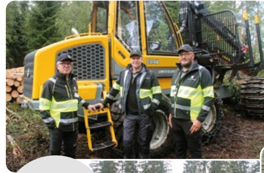
8-pyöräinen ajokone Sampo-Rosenlew FR68 painaa 18 tonnia ja kuormaa kone voi ottaa 14 tonnia.
