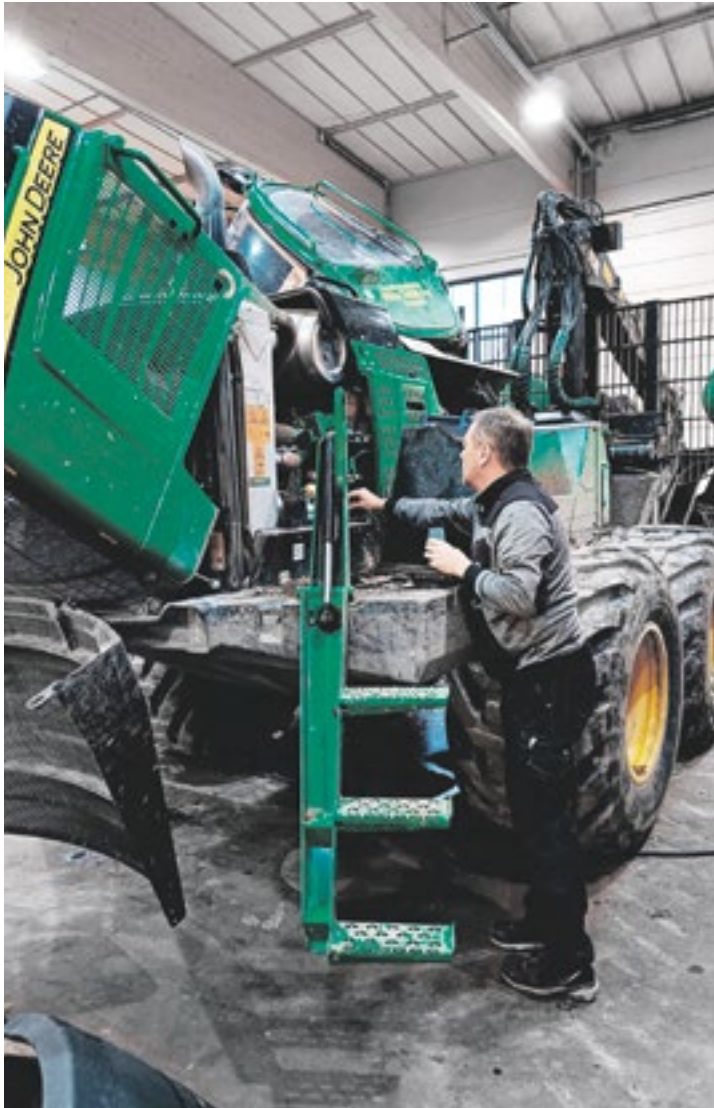
Janne Kähkönen tekee metsätraktorille paloturvallisuustarkastusta. Erilaiset sähköjohdotukset aiheuttavat 58 prosenttia kaikista konepaloista ollen ylivoimaisesti suurin palon syyntymissy. Johdotukset ja muut sähkölaitteet ovat siis yksi keskeisistä tarkastettavista kohteista.
