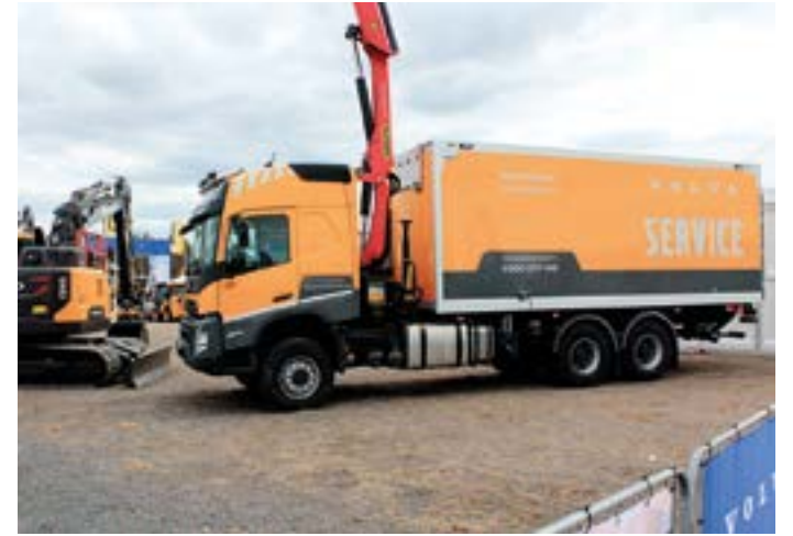
Pohjoismaiden suurin huoltoauto, Volvo FMX380 6x6 nähtiin Volvon osastolla. Auton avulla huolto- ja korjaustyöt onnistuvat myös haastavimmissa kaivosolosuhteissakin.
