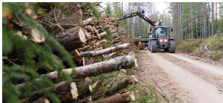
Kesla C645 rumpuhakkuri vaatii eteensä yli 140-kilowattisen traktorin.
