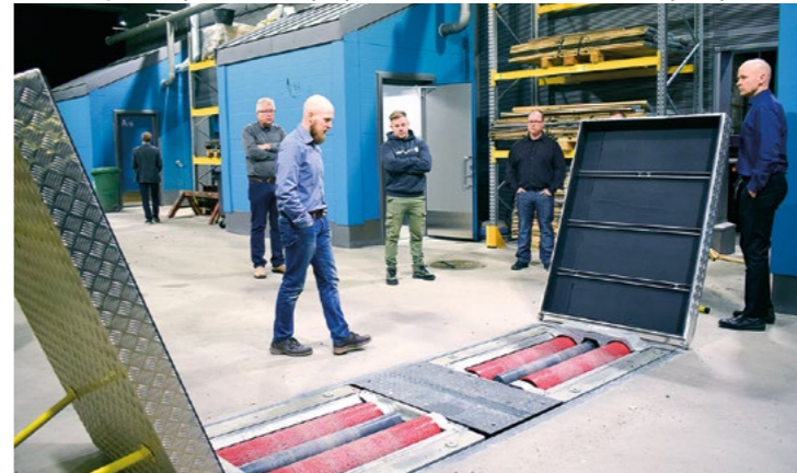
Jarrudynamometri on korjaamorakennuksen päädyn katoksessa.
