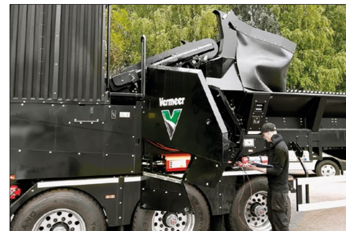
Vermeerin murška sai kahdella sumutesäiliöllä varustetun sammuttimen konehuoneeseensa.
