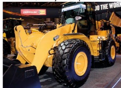
Cat 950GC sähkökoneen prototyyppiä on 600V/256kWh akusto ja koneen paino on 19,7 tonnia.
