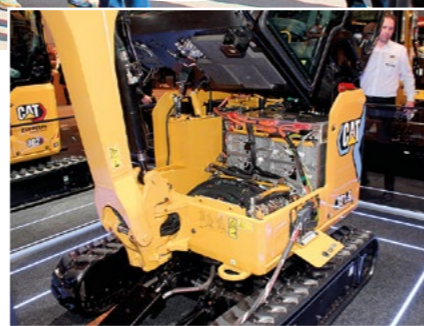
Cat 301.9 on sähköinen minikaivukone, koneen akusto on 48V/32kWh ja koneen paino on 2 tonnia.
