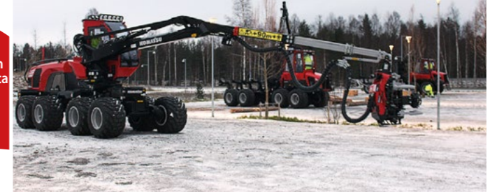
Testattavissa oli myös uudella Smart Crane -nosturilla varustettu Komatsu 901 XC. Smart Cranen avulla kuljettaja ohjaa koko nosturia, nostopuomista teleskooppipuomin kärkeen asti, yhdellä sujuvalla kahvan liikkeellä.
