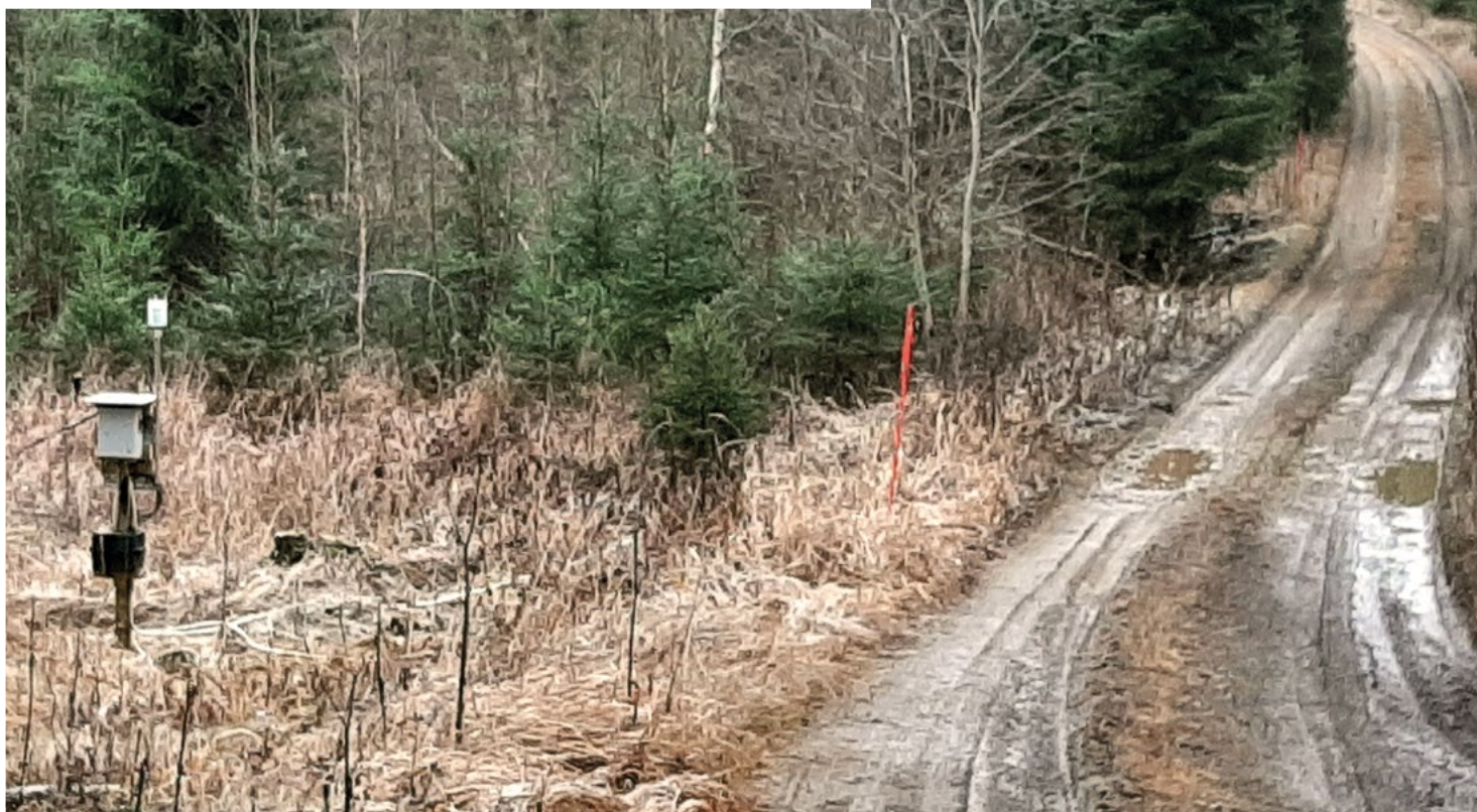
Mittausasema tallentaa muun muassa vallitsevan sään sekä metsätien kosteuden reaaliaikaisesti. Matti Savinainen / Luonnonvarakeskus.
