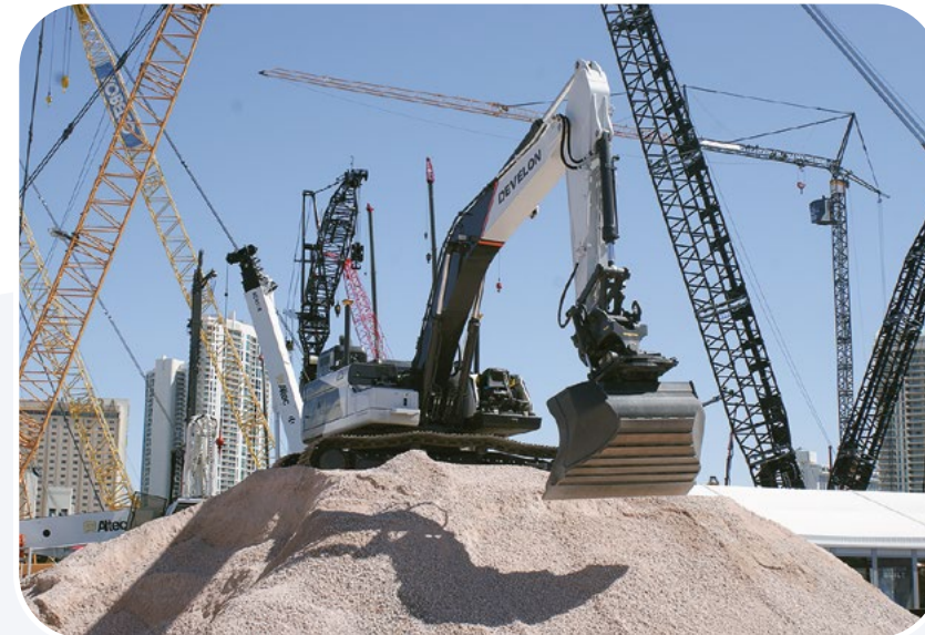
Develonin CONEXPO-osastolla pidettiin kolme kertaa päivässä näyttös, jossa koneet työskentelivät itsenäisesti. Vuonna 2019 lanseerattu autonomisten koneiden konsepti Concept-X on nyt päivitetty Concept-2X:ksi. Näytöksissä esiintyi tämä autonomisesti toimiva tela-alustainen DX225-CX kaivukone ja autonominen puskukone DD100-CX. Autonomisuus näkyy muotoilussa, koneissa ei ole lainkaan ohjaamoa.
