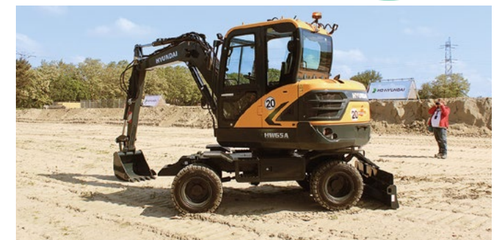
Hyundai HW65A on pyöräalustainen uusi malli, jonka teho on 48,5 kilowattia.
