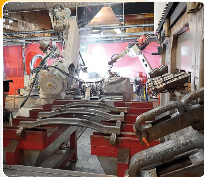
Telojen robottihitsauspiste Olofsforsin uudessa tehtaassa.
