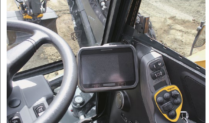
Hyundai HW100A:n ohjaamossa on 8 tuuman kosketusnäyttö.
