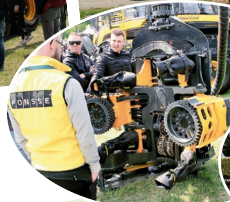
Uusi Ponsee H8 järeä 1400 kiloa painava koura. Kourassa on kolme syöttörullaa ja aukeama on 740 mm.
