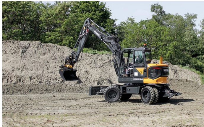
Hyundai HW100A oli aivan uusi malli ja uusi koko. Pyörät kääntyvät molemmissa päissä.
