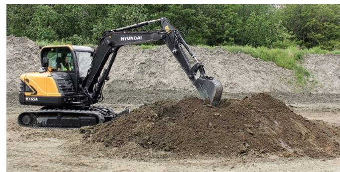
Hyundai HX65A on tela-alustainen uusi kone, jonka teho on 48,5 kilowattia.
