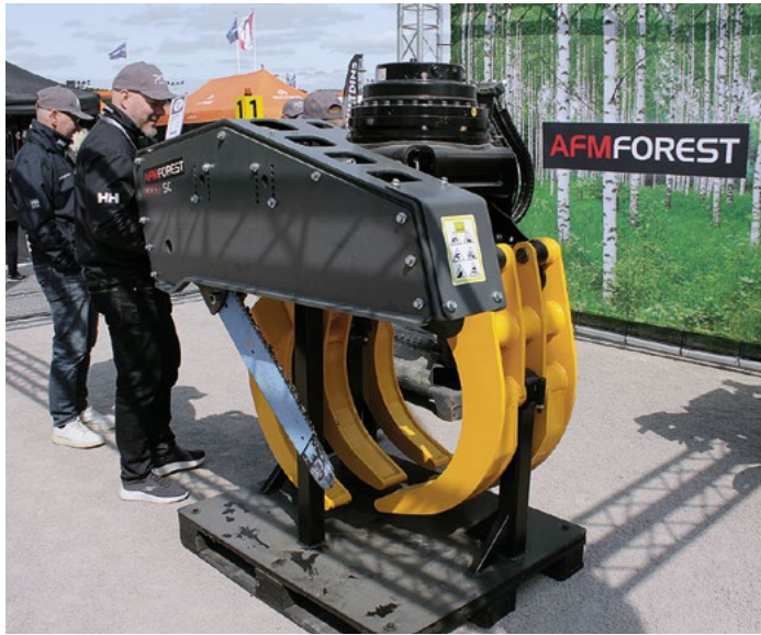
AFM-Forestin uusi järeä sahakasetti erilaisiin kouriin ja kahmareihin.
