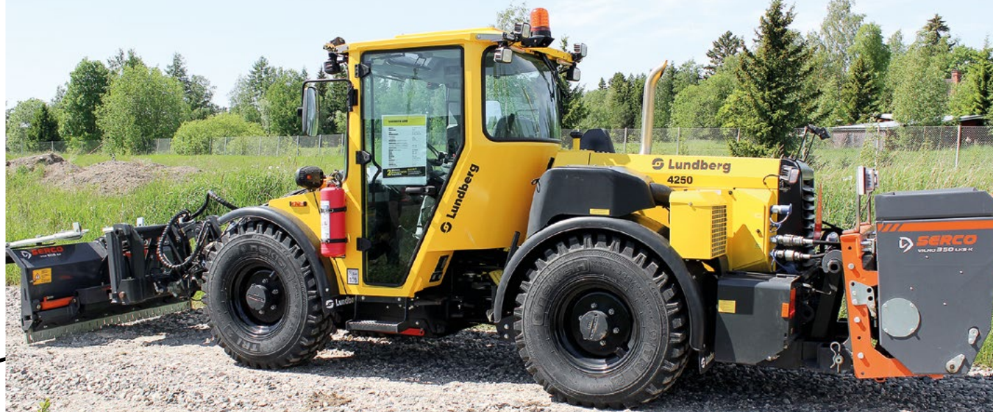
Lundberg ympäristönhoitokoneiden valmistus siirtyy Ruotsista Loimaan Lännen MCE Groupin tehtaalte kokonaisuudessaan. Kuvassa on Lundberg 4250 varustettuna Serco etuauralla ja takahiekoittimella.
