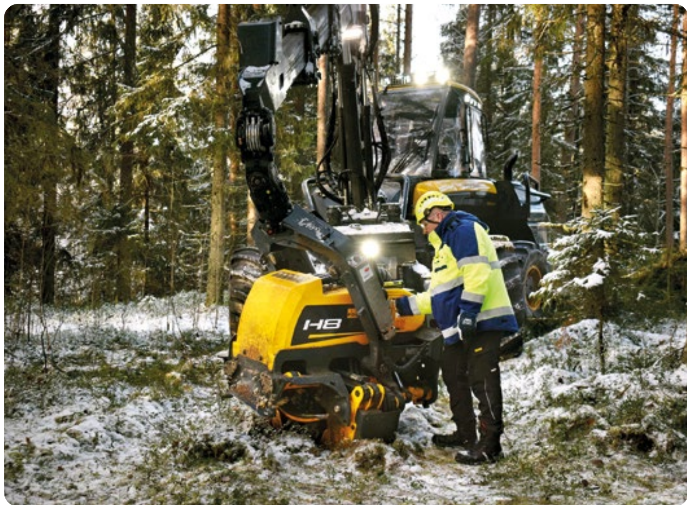
Uuden teräketjujen rasvausjärjestelmän saa Suomessa uusiin metsäkoneisiin H8-, H7- ja H6-hakkuupäihin. Kuva: Ponsse Oyj
