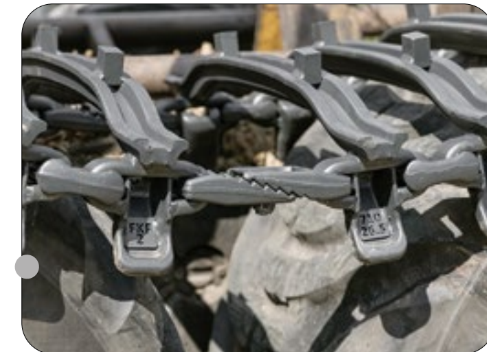
FinnMETKO 2024 messuillakin esitelty uusi telamalli TerraX ja sen hammastuksella varustettu liitoslenkki eli hammaslenkki. (Kuva: Nordic Traction Group)
