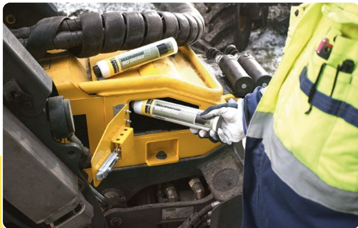
Uuden teräketjujen rasvausjärjestelmän saa Suomessa uusiin metsäkoneisiin H8-, H7- ja H6-hakkuupäihin. Kuva: Ponsse Oyj
