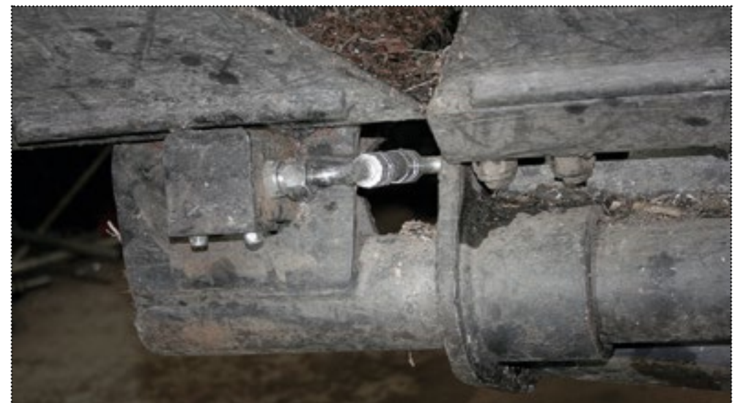
Metsätraktorin perään on asennettu jälkikäteen lisävalot. Tarkastuksessa todettiin, että lisävalojen sähkön otto ja johtojen suojaus on tehty asianmukaisesti.
