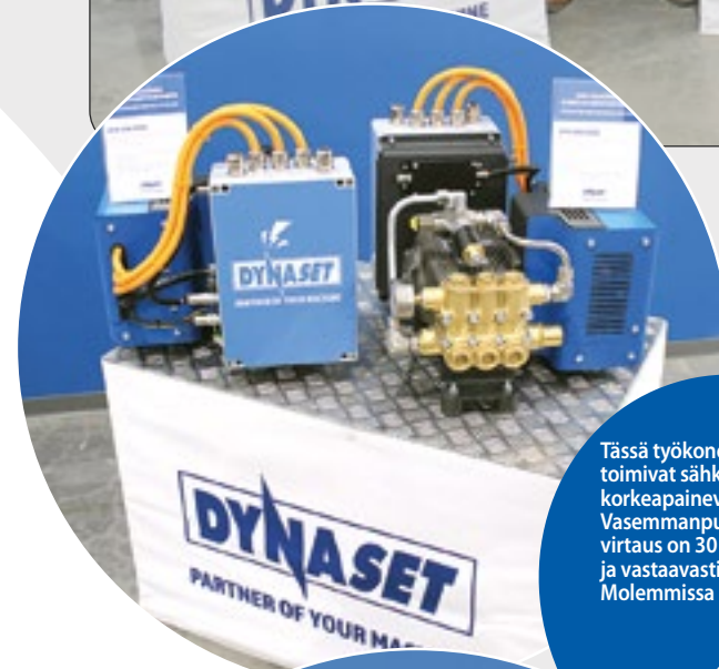
Kuvassa on uusi verkkovirralla toimiva korkeapainevesipumppu tuottaa paineettä 150 barin paineella 15 litraa minuutissa.
