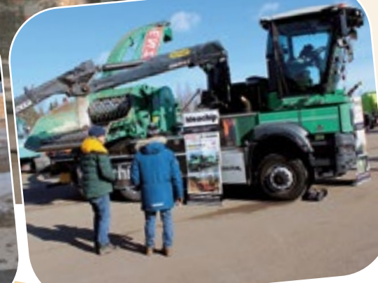
Ideachip Machine esitteli Jenz HEM 593 Cobraa. Hakkurissa on kääntyvä Claas ohjaamo, uusimpiin tulee vastaava Jenzin oma ohjaamo.
