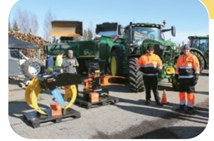
AFM Forestin Jari ja Topias esittelivät uutta pienintä mallia AFM 600 SC sahakasettia. Se sopii kaikkiin kourisiin. Vieressä on tiltaava kaatokourapaketti sahauskasetilla.
