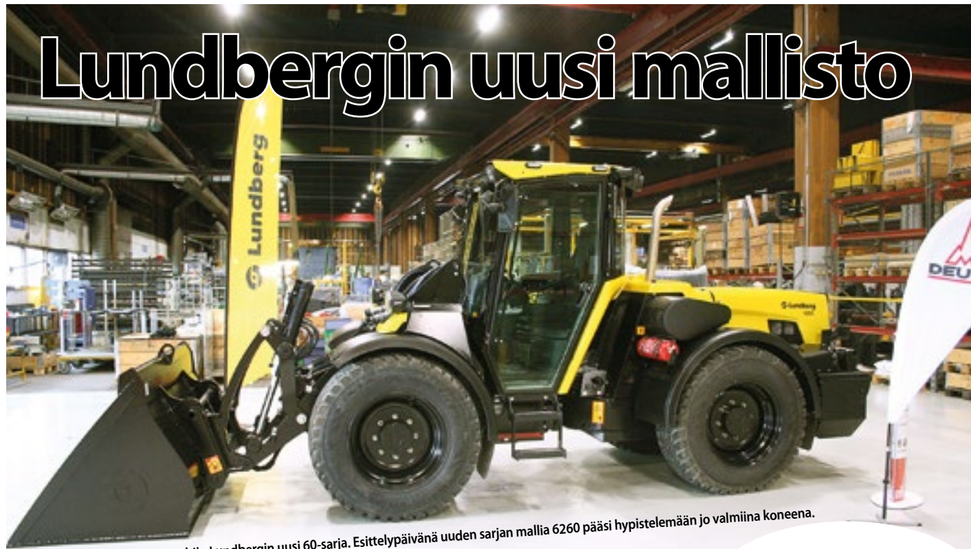
Mallistossa on uusittu muun muassa konepeitto ja sen aukeaminen. Uusi konepeitto aukeaa joko ylös tai taakse, jolloin konepeiton saa auki parhaalla mahdollisella tavalla lisälaitesijoittelusta riippumatta.
