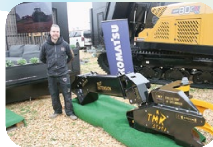
TMK Tilt Extension on tilitillä varustettu jatkopätkä energiakouran kanssa. Tiltti eliminoi kauhauksen sylinterin käytön, joten se on nopeampi ja aikaa säästyy sekä se on polttoainetehokkaampi, kertoi Robert Kurki.
