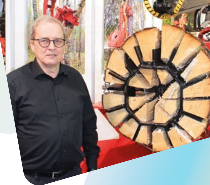
Pentin Paja Oy:n Mikko Häikiö esitteli perävaunun päälle rakennettua Naarva 60 pilkkuria. Uutuutena on hydraulinen nostin, jolla on helppo nostaa painavakin pölli halkaisutelineelle, mikäli nosturin käyttö ei miellytä.
