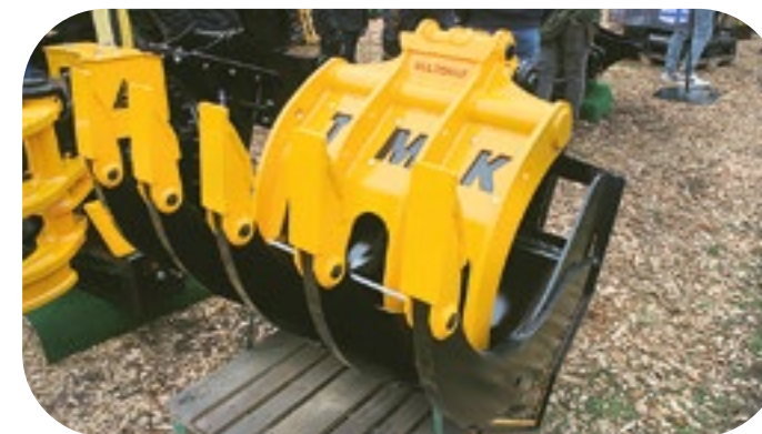
Uusi TMK multikoura esiteltiin messuilla, se on raskaampi HD heavy versio. Koura on tarkoitettu raskaampaan ja monipuolisempaan käyttöön.
