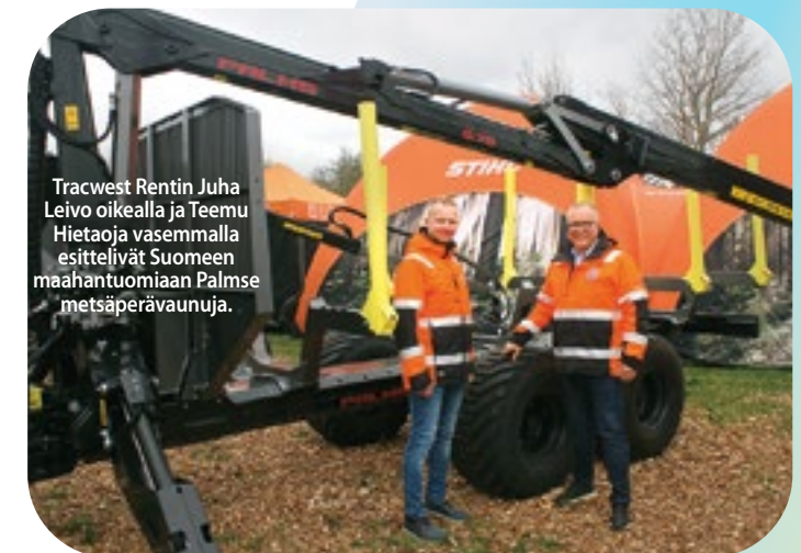
Palmse metsäperävaunun uusi pitkä runkoryyppi. Perävaunussa on levitettävät pankot.
