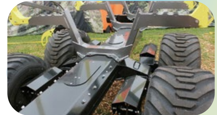
Palmse metsäperävaunun uusi pitkä runkoryyppi. Perävaunussa on levitettävät pankot.
