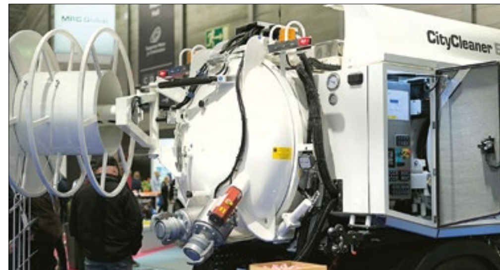
KAISER on hyvin usein esittelemässä erikoiskalustoaan Yhdyskuntatekniikka-näyttelyssä. Niin tälläkin kertaa: Esillä oli KAISERin CityCleaner EV-imupesauto, joka perustuu Volvon FM Electric 4x2 -kuorma-auton alustaan.
