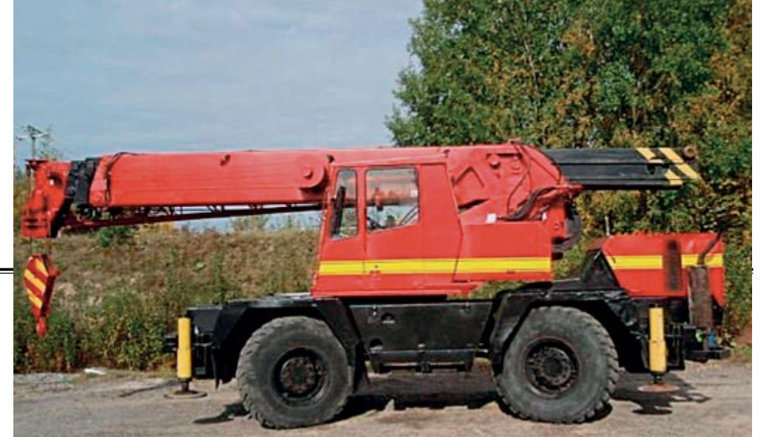
"Aku Ankka" sai kutsumanimensä koneen mallimerkinnän MS 313 N mukaan. Ja niin kuin kuvasta näkyy, konepelti oli aina vaarassa, jos ylävaunua käännettiin ennen kuin puomia oli ajettu ulos. Käännölle oli kyllä rajatkaisin, mutta joskus kuljettajilta se unohtui väärään asentoon!
