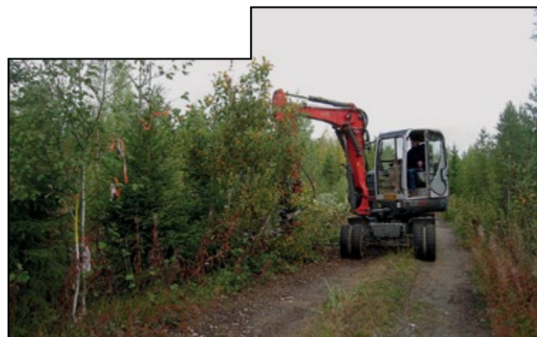
Kuva 1. Pyörivä spiraali kahmaiseen vesakon leikkaavaa terää vasten, jonka jälkeen pystyyn jää enään kanto. Tutkimuksessa koealojen rajat merkittiin kuitunauhalla ja merkkimaalilla. Raivattava tienvarsivesakko koostui pääosin pajusta, muusta lehtipuustosta ja kuusista.
