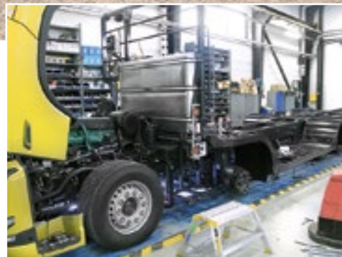
Suomeen valmistamat koneenkuljetusautot ovat lähes poikkeuksetta 5-akselisia. Volvo FH16 750 alustalle rakennettu koneenkuljetusauto on jo maalattu ja viimeistelyä vaille. Auto on menossa Metsäkoneurakointi J. Nousiainen Oy:lle Kerimäelle.
