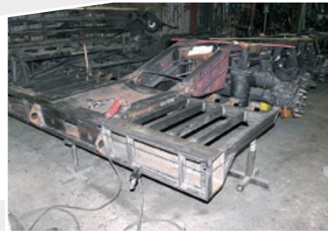
Scania G540 auto on rakenteilla. Teräsrakennetöitä tehdään, hitsataan ja kasataan. Kun kaikki on valmista, auto hiekkapuhalletaan ja maalataan.
