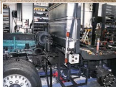
Polttoainetankki on laitettu ohjaamon taakse litteänä pystyyn. Etuakseleiden väliin tulee tavaralaatikko.
