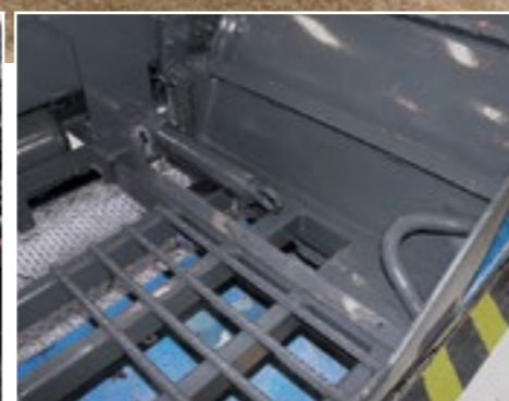
Koneen kiinnityksen hydraulinen kiristin on omaa mallia. Asiakkaan toiveesta laitetaan myös esimerkiksi Kiesitechin kiristimiä.
