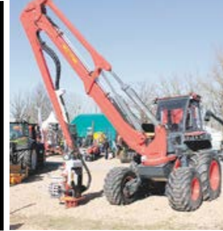
Marttiin uudet jyrsimet soveltuvat esimerkiksi asfaltin aukaisuun kaapelointeja varten tai asfaltin jyrsimiseen isommalta alueelta, kertoi Miika Marttini.
