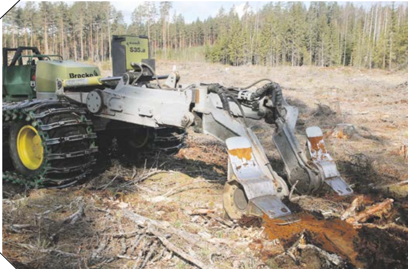
Kaksirivinen Bracke M24.a -maanmuokkain, johon on integroitu Bracke S35.a -kylvölaite. Kuva: Bracke Forest AB.
