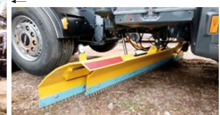
Haapasora Oy valmistaa Sepeko kuorma-auton alusteriä, jotka sopivat kaikkiin kuorma-autoihin. Auramallille on ominaista korkea runko ja laaja säädettävyyttä.
