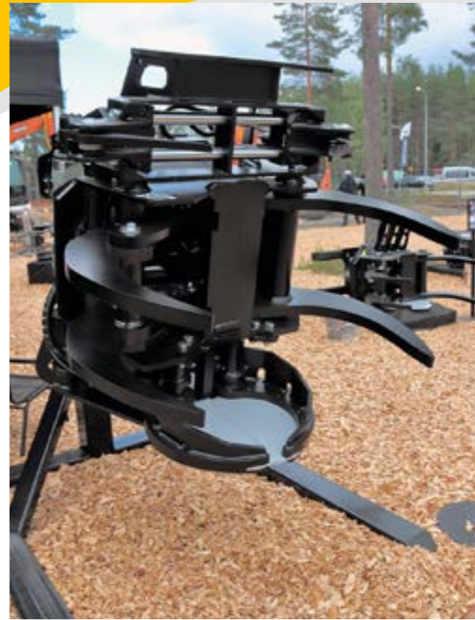
Jak-300 on valmistajansa Jak Metalli Oy:n ensimmäinen C-mallin energiakoura on tarkoitettu käytettäväksi 5-25 tonnin kaivinkoneissa.
