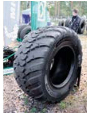
Euromasterin TrailXB on VF ultraflex -teknologialla tehty vyörakenteinen joustavampi vyörakenteinen perävaunurengas, joka lisää kantavuutta ja siinä voidaan käyttää pienempää ilmanpainetta ja siten vähentää maahan kohdistuvaa pintapainetta.
