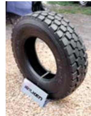
Falken-renkaat tulivat markkinoille viime kesänä. Kiviatorenkassa ei ole erillistä runkovahevikettä, vaan kumilaatu on valikoitu pistonkestävyyden parantamiseksi.
