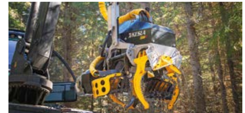
Kesla 21RH-III voidaan varustaa proAX- saksikatkaisulla ja joukkokäsittelypihdeillä, jotka ovat parhaimmillaan energiapuun korjuussa. Neliteräinen 26RH-III soveltuu niin harvennuksiin kuin pätehekkueillekin.
