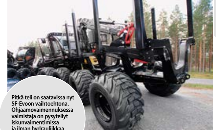
5F-ajokoneen eturunkoa uudistettu. Nokkaa on lyhennetty 50 mm tiivistämällä lauhdutinpakettia ja jäädytymiä sekä muita osia. Ketteryys on kasvanut ja huoltokohteisiin pääsy parantunut.
