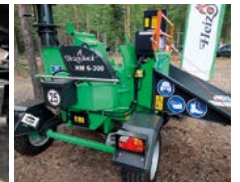
Pienempi Heizohack HM6 traktorihakkuri kykenee 15-20 kuution tuntutuotantoon. Puun max. halkaisija on 300 mm.
