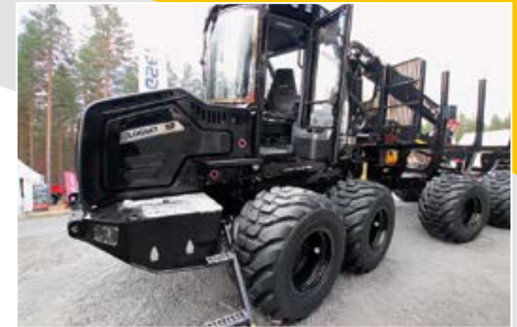
5F-ajokoneen eturunkoa uudistettu. Nokkaa on lyhennetty 50 mm tiivistämällä lauhdutinpakettia ja jäädytymiä sekä muita osia. Ketteryys on kasvanut ja huoltokohteisiin pääsy parantunut.
