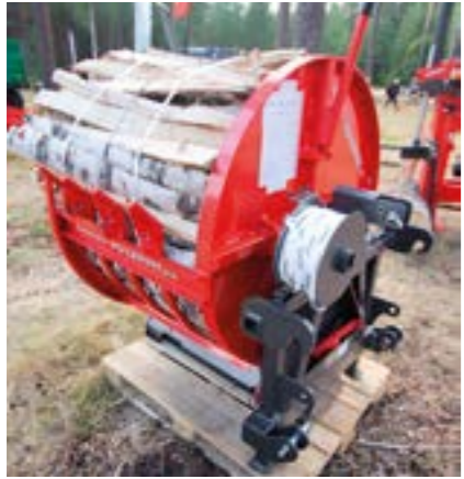
Hakki Pilke 55 Pro on yhdessä HakkiFeed 472 -tukkipöydän ja XL-poistokuljettimen kanssa varsinainen polttopuutehdas, jonka toiminnot ovat pitkälti automatisoituja.
