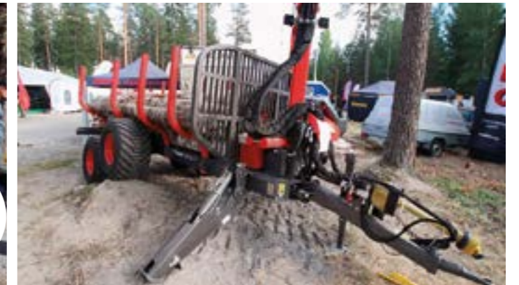
I Heinilän uutuus on Krpan GP10DF metsäperävaunu. Kanatavuus 10 tonnia ja kuormaimen ulottuvuus 600 kg nostokyvyllä vielä 6,6 metriin. Verollinen hinta 32 000 euroa.
