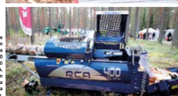
Vöyrin kone ja traktorin maahantuoma Tajfun 400 sisältää runsaasti automatiikkaa, joka estää pölkyn putoamista väärässä asennossa halkaisukouruun.
