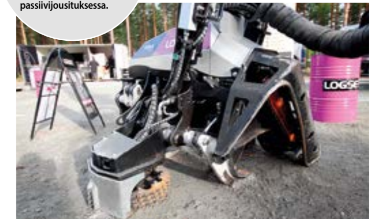
Logset TH65 3.3n-kourassa on nyt uusittu venttiililohko. Muotoilulla ja piiloletkukutsella painoa on saatu 100 kg alemmaksi edelliseen versioon verrattuna.
