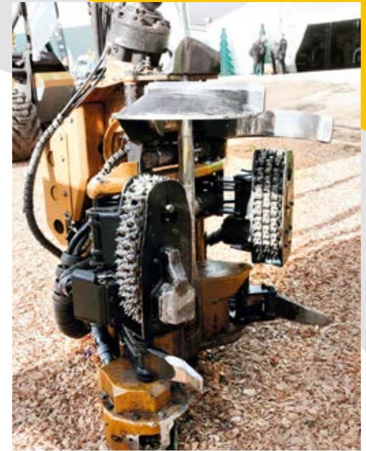
Sampo Rosenlewin alustakoneessa oli uusi neliteräinen Keto-kouramalli 150 Multi. Monitoimikoneella hoituu myös pienpuun keruu. Katkaisuläpimitta on optimiltaan 400-500 litraisille puille.
