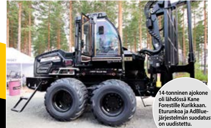
Logset TH65 3.3n-kourassa on nyt uusittu venttiililohko. Muotoilulla ja piiloletkukutsella painoa on saatu 100 kg alemmaksi edelliseen versioon verrattuna.
