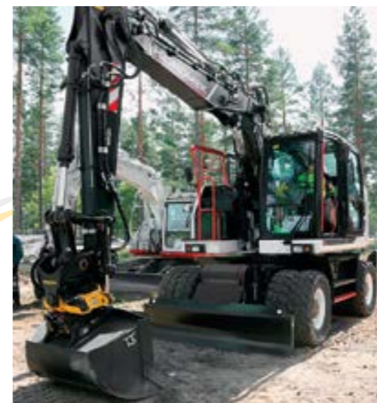
Honkatrading Oy:n Hidromek HMK 210W H4 painaa 22,4 tonnia ja siinä on Isuzun nelisynterinen 128 kW moottori.
