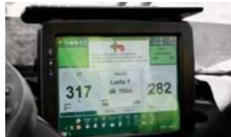
IBC 3.0:n syötön avustin varoittaa kuljettajaa vaaratilanteesta. Kuva: Sirpa Heiskanen
