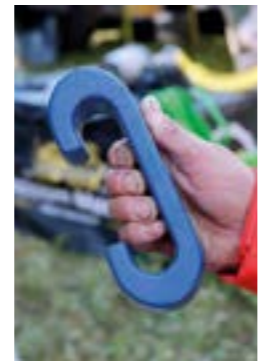
Koppom Maskin osastolla esitely uusi taattu telaketjun ketjulenkki, jonka kulutuskestävyys on huomattavasti suurempi kuin lattaroudasta taivutetussa lenkissä.
