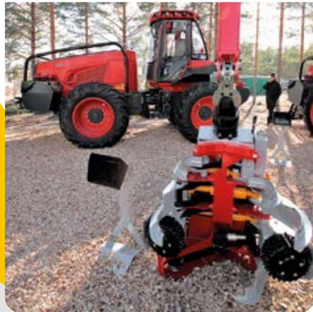
Nisula N6e varustettuna Palfingerin S110 nosturilla
