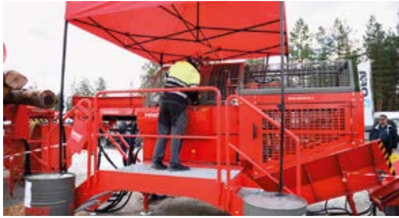
Hakki Pilke 55 Pro on yhdessä HakkiFeed 472 -tukkipöydän ja XL-poistokuljettimen kanssa varsinainen polttopuutehdas, jonka toiminnot ovat pitkälti automatisoituja.
