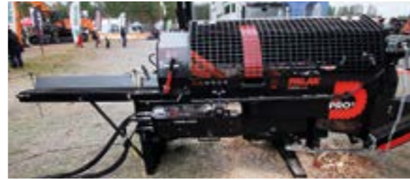
Palax D410 on teräketjukone, joka sopii parhaiten halkaisijaltaan isoa ja vaihtelevaa puuta tekeville. Lisävarusteena saatava X-Aim säättää halkaisuterän automaattisesti aina keskelle puuta.
