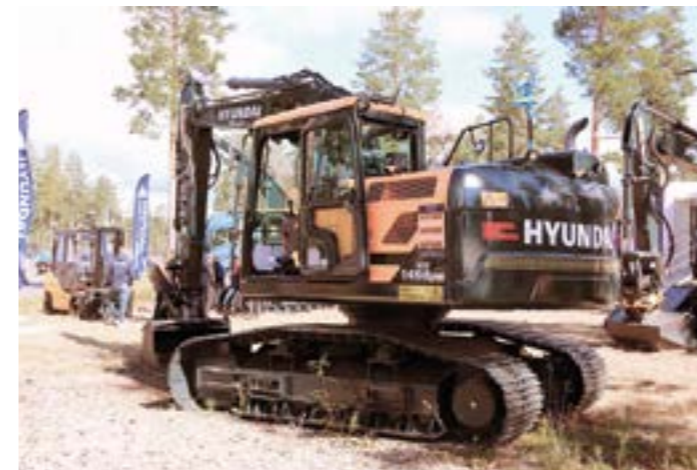
Hyundai HX140 HW-metsäalustalla ja 800 mm lapuilla painaa vajaat 17,5 tonnia. Moottorina on 100-kilowattinen Cumminsin F3.8. Hydraulikasta huolehtii kaksi 123,5 l/min 380 bar pumppua.
