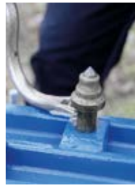
Lintexonin Saurus-piikki on helppo vaihtaa uuteen yksinkertaisella työkalulla.
