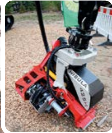
Nisula 425H on lisäerillä varustettu harvennushakkuukoura.
