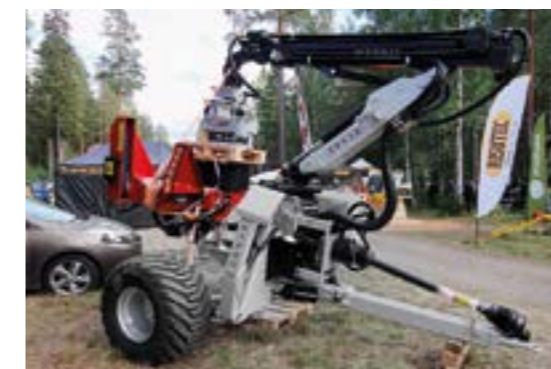
Hypro 755 HB on vajaa 3 tonnia painava hinnattava prosessori yli 70 hv traktoreihin. Suurin puun halkaisija 500 mm ja karsinta 400 mm saakka.
