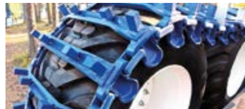
Telavalmistaja Lintexon Tracks esitteli alunperin Kanadan rinnemaastoihin tehtyjä hokkeja, joita saa eri pituisina ja määrinä telaa kohti.
