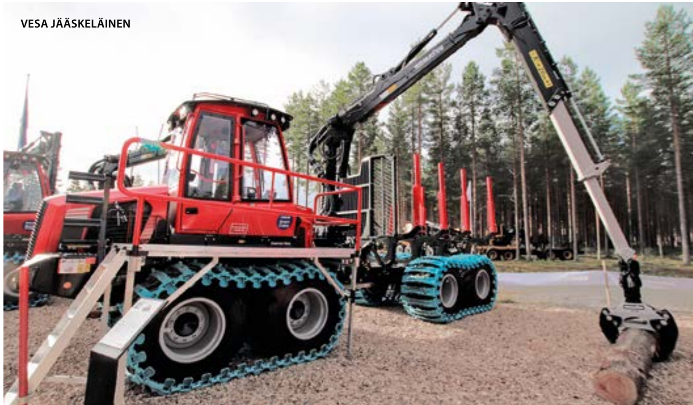
Smart Crane -kärkiohjauksella varustettu Komatsu 845 on 12 tonnin kuormatraktori, joka on parhaimmillaan harvennuksilla ja pehmeillä mailla mutta sopii myös pätehekkuille.
