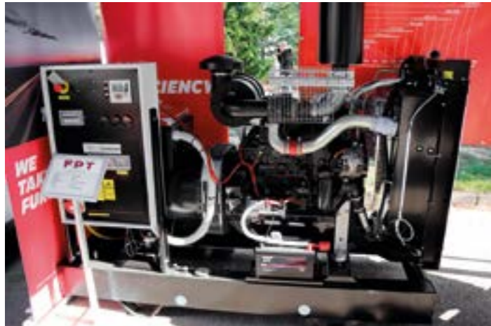
Tapimerin 100 kVA:n aggregaattia pyörittää 4,5-litrainen FPT-dieselmoottori.
